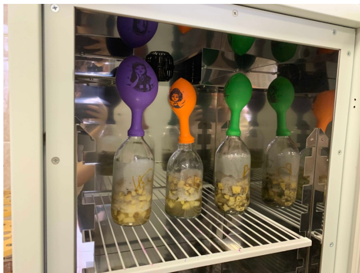
Рис. 1. Процесс образования биогаза
