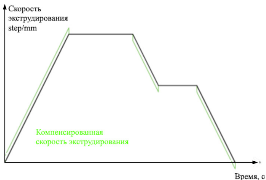
Рис.3. График компенсации скорости продвижения
