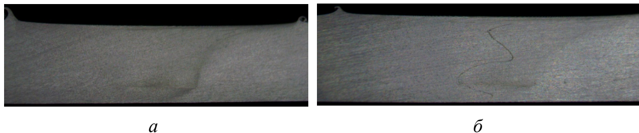
Рис.3. Макрошлифы сварных соединений, после обработки кромок: a – фрезерованием и обезжириванием уайт-спиритом; б – без подготовки кромок
