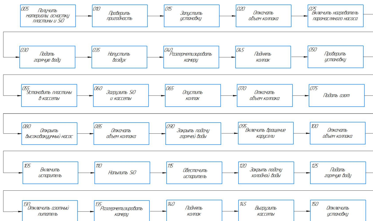
Рис. 1. Технологический процесс термического резистивного напыления SiO
