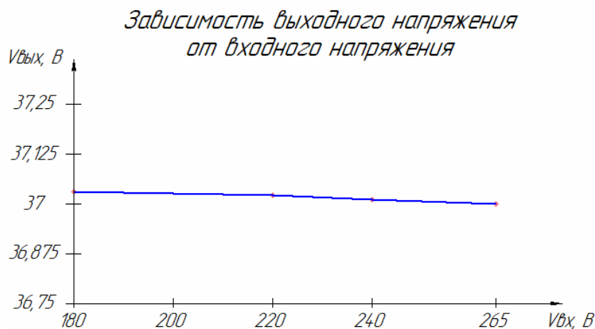
Рис. 3. График зависимости выходного напряжения от входного
