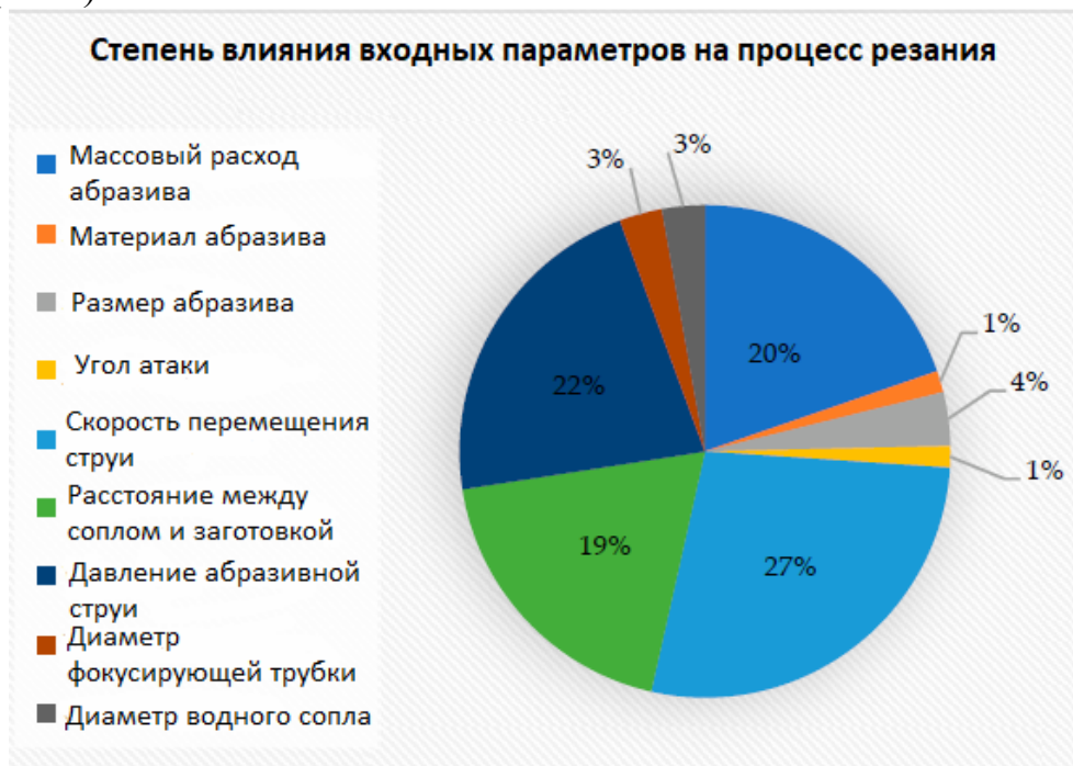
Рис. 2. Диаграмма влияния некоторых входных параметров на процесс гидроабразивной резки
