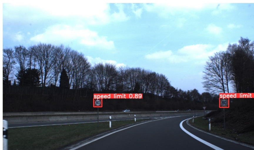
Рис.3. Изображение с отмеченными распознанными знаками
