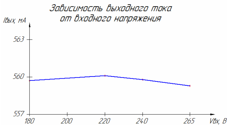
Рис. 2. График зависимости выходного тока от входного напряжения
