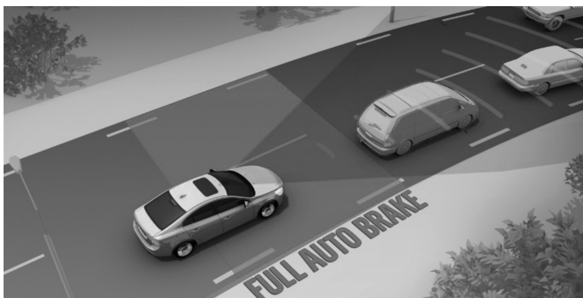
Рис. 2. Схема считывания дороги радаром
