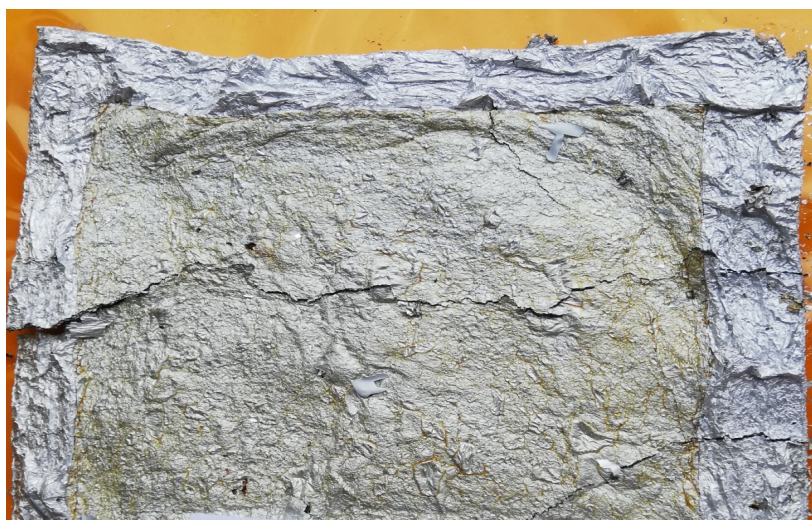
Рис. 3. Образец № 2 после термических испытаний
