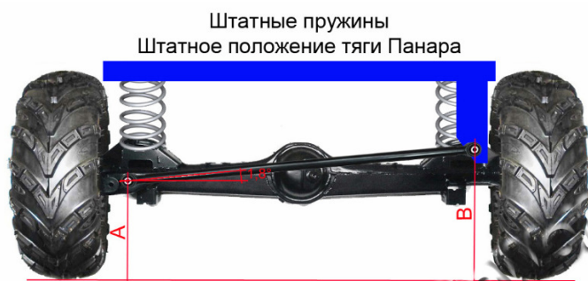
Рис. 4. Расположение тяги Панара
