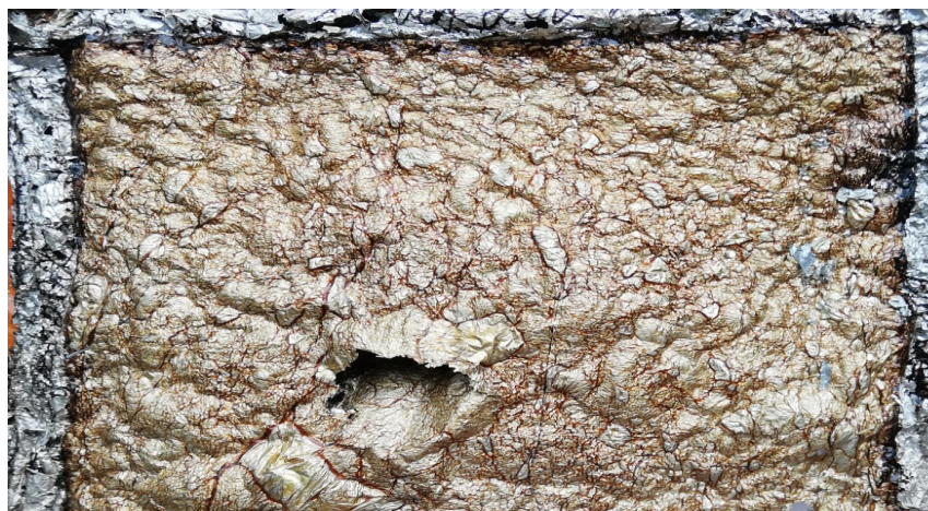
Рис. 4. Образец № 3 после термических испытаний
