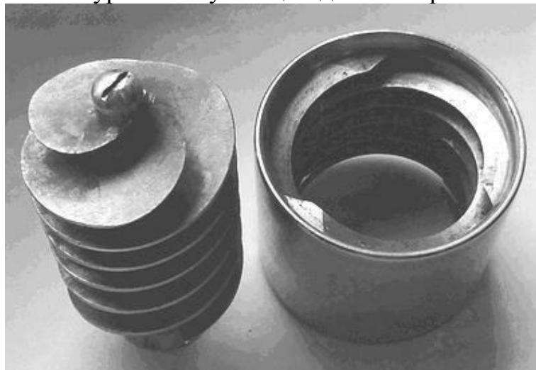
Рис 2. Конструкция осевихревой ступени
