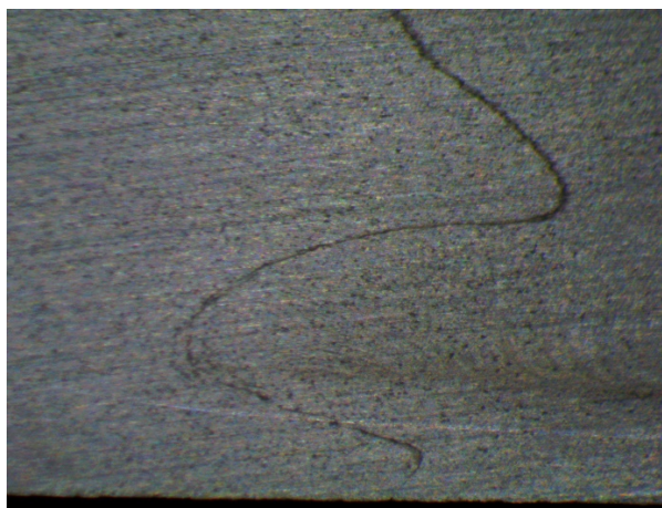
Рис. 2. Оксидные включения в сварном шве
