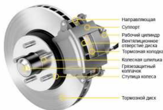
Рис. 1. Дисковый тормозной механизм
