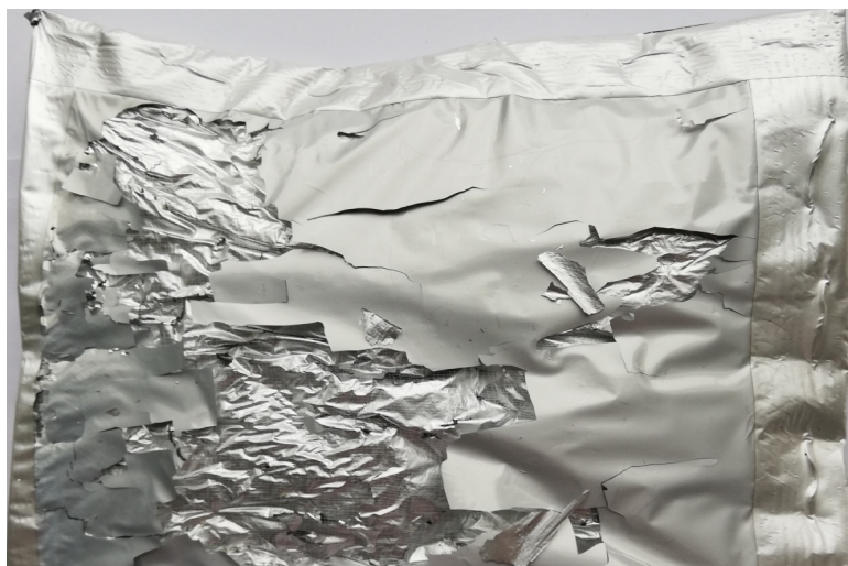
Рис. 2. Образец № 1 после термических испытаний
