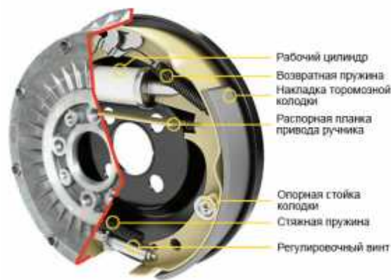
Рис. 2. Барабанный тормозной механизм
