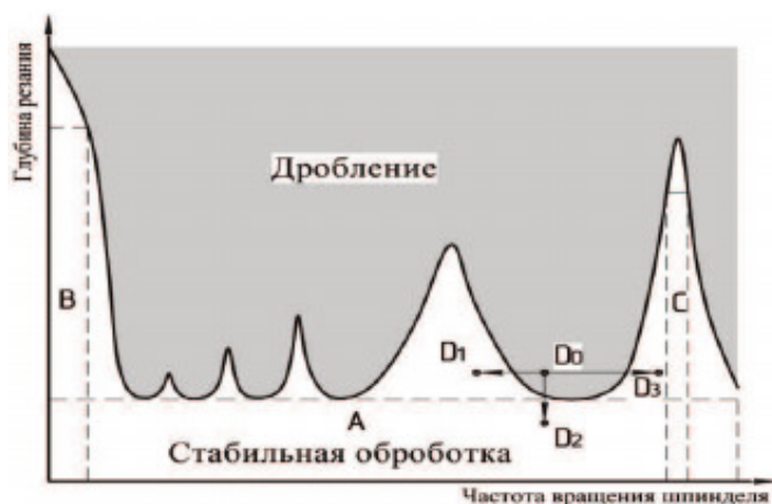
Рис. 3. Характерный профиль зон обработки в зависимости от частоты вращения шпинделя
