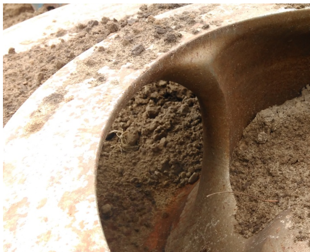
Рис. 1. Износ входной кромки лопасти рабочего колеса
