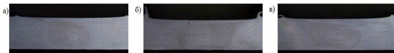
Рис. 3. Макрошлифы образцов с зазором 2 мм длиной 26 мм (а), 40 мм (б) и 80 мм (в) с добавлением проволоки АМг5
