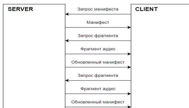
Рис. 1. Обобщенная схема адаптивной потоковой передачи аудиоданных
