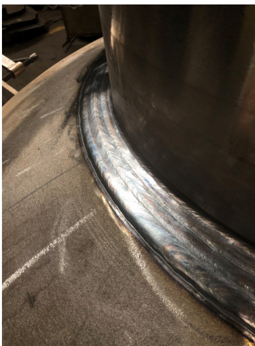
Рис. 8. Кольцевой шов углового соединения патрубка с днищем
