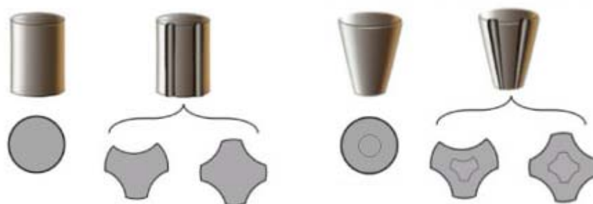
Рис. 3. Конструктивное исполнение пина инструмента для СТП
