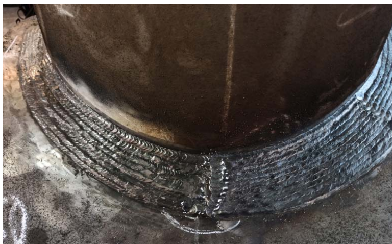
Рис. 1. Сварное соединение патрубка и обечайки
