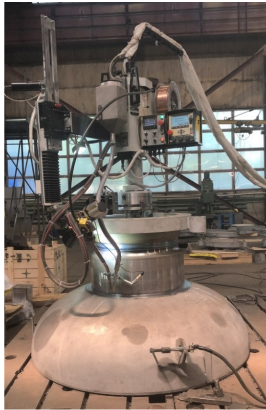
Рис. 7. Сварочная головка, установленная на патрубок
