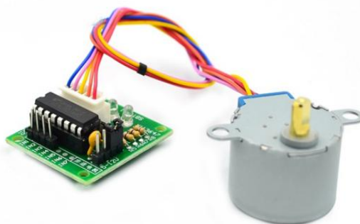
Рис. 3. ШД 28YBJ-48 с редуктором
