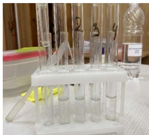
Рис. 4. Определение ионов железа Fe^{3+}
