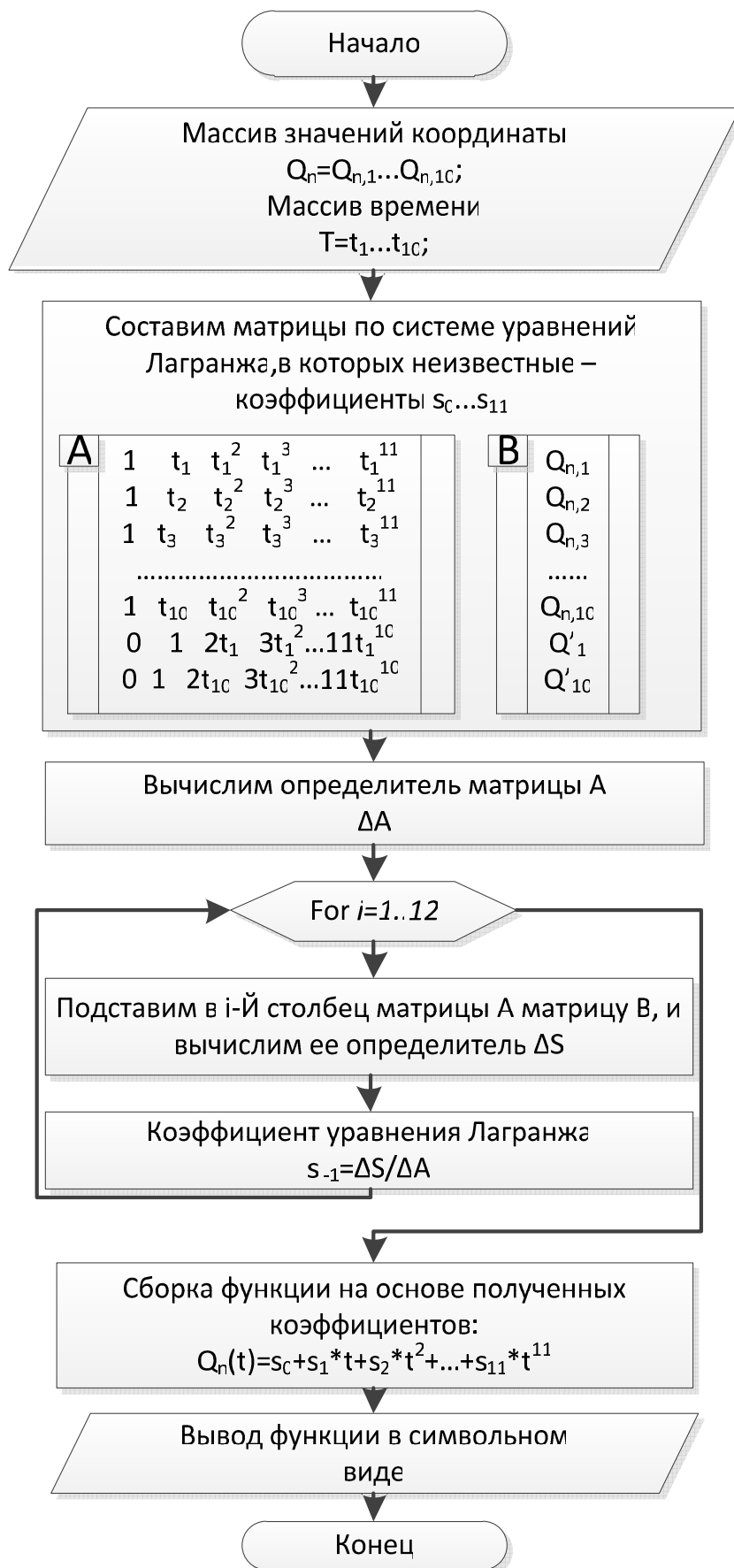
Рис. 3. Блок-схема алгоритма интерполяции функции закона изменения координаты Q
