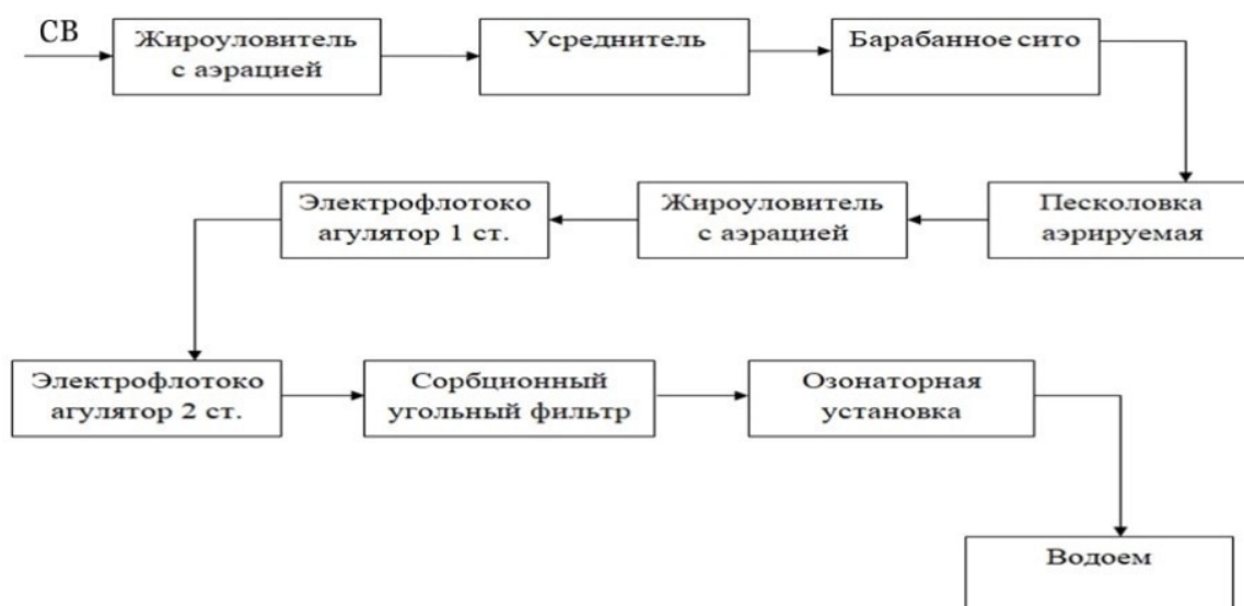
Рис. 3. Блок-схема очистки сточных вод мясокомбинатов с применением озонаторной установки
