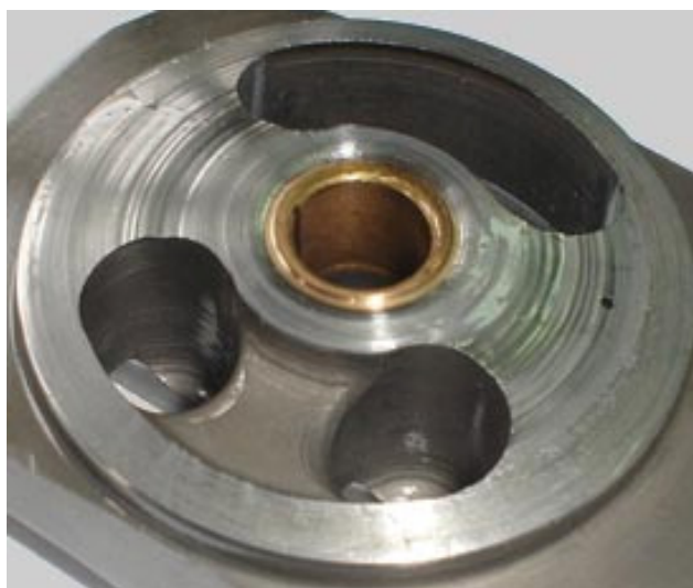
Рис. 1. Повреждение распределительного блока аксиально-поршневого насоса
