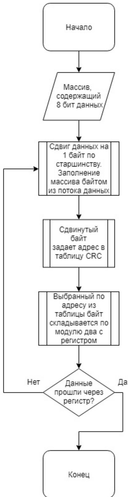
Рис. 2. Алгоритм вычисления контрольной суммы CRC8
