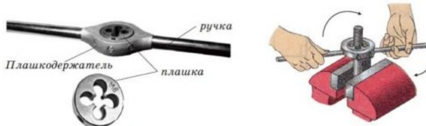
Рис. 6 Использование плашки для нарезки трубной резьбы
