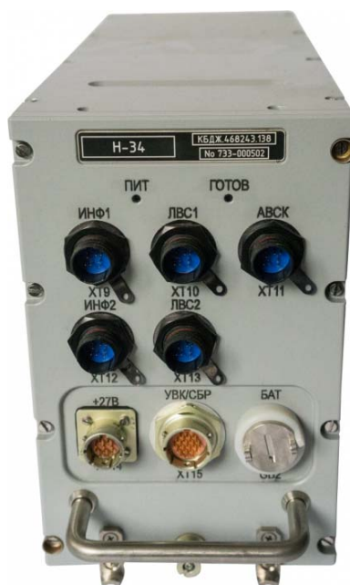
Рис. 1. Блок криптографической защиты информации унифицированной системы радиосвязи
