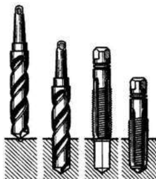
Рис. 7. Последовательность получения резьбы
