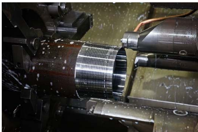
Рис. 8 Методика нарезки резьбы на токарном станке
