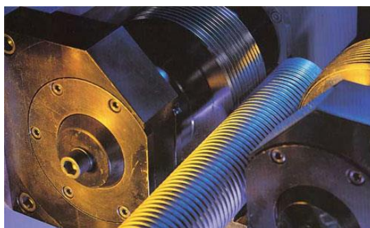
Рис. 7 Нанесение резьбы методом накатки
