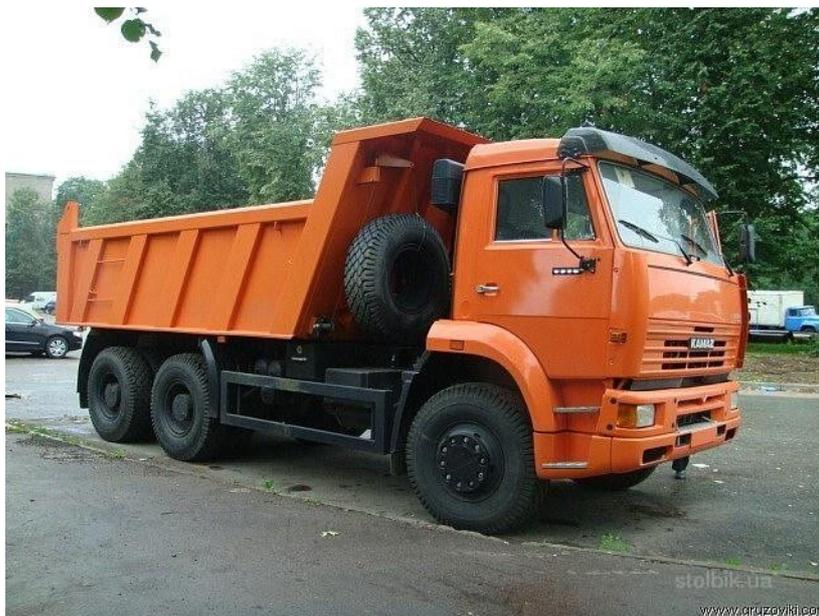
**Рис. 2.** Трехосный грузовой автомобиль КамАЗ-6520
