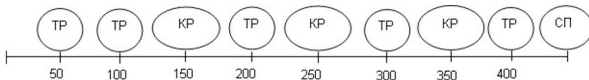
Рис. 2. Структурная схема ремонтных циклов дизелей КАМАЗ
