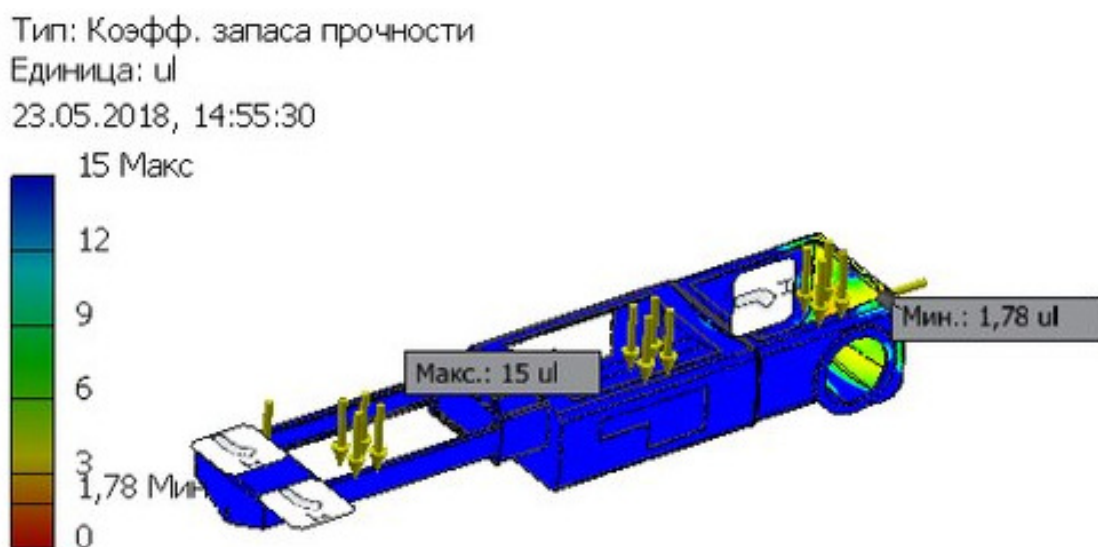
Рис. 3. Графика распределения коэффициента запаса прочности
