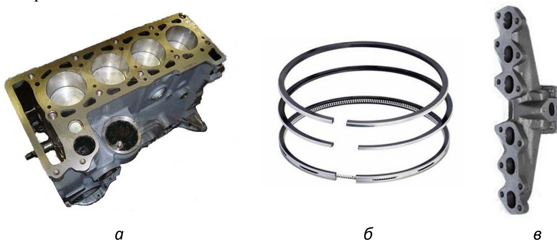
Рис. 1. Детали из серого чугуна: а – блок цилиндров двигателя внутреннего сгорания, б – поршневые кольца, в – выпускной коллектор
