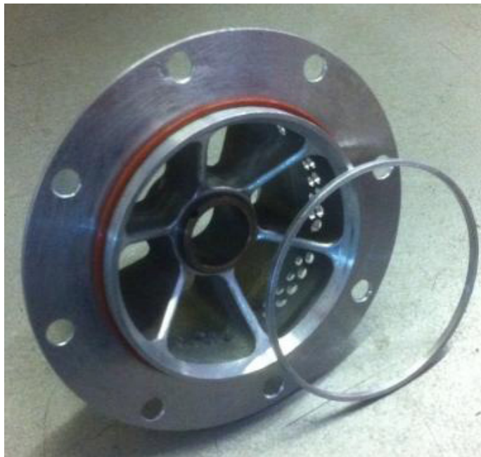
Рис. 2. Участок трубопровода с перфорацией и направляющим аппаратом
