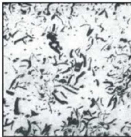
Рис. 4. Микроструктура серого чугуна (до травления) [1]
