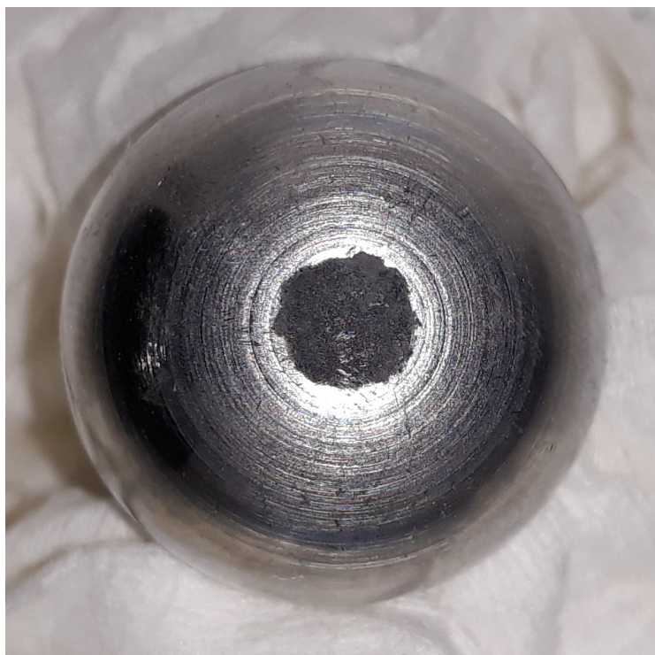
Рис. 6. Шаржирование порошка, образовавшегося в процессе износа МДО-покрытия площадки, в контактирующую поверхность материала упора (сталь 20Х13)
