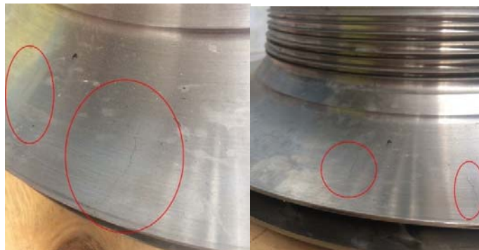
Рис. 1. Внешний вид трещин на покрывающем диске крыльчатки
