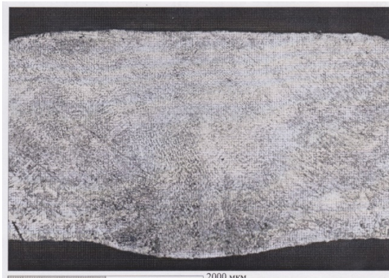
Рис. 8. Фотография микрошлифа сварного соединения
