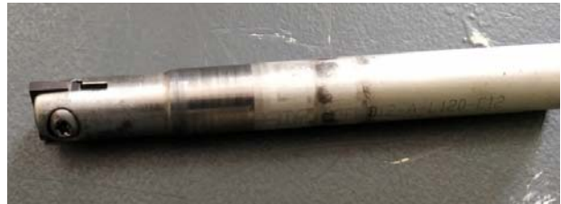
Рис. 3. Фреза ISCARHCE 012-A-L120-C12
