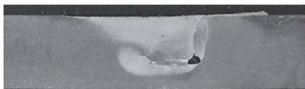
Рис. 5. Полость, образованная из-за недостаточного тепловложения [3]
