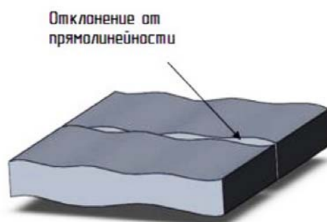
Рис. 6. Пример отклонения от прямолинейности на металлических пластинах [9]
