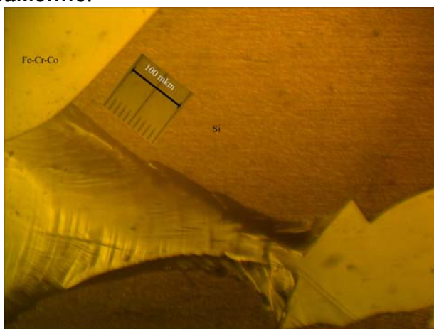
Рис. 3 Вид зоны разрушения пленки
