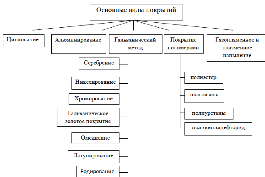
Рис. 1. Основные виды покрытий металлов
