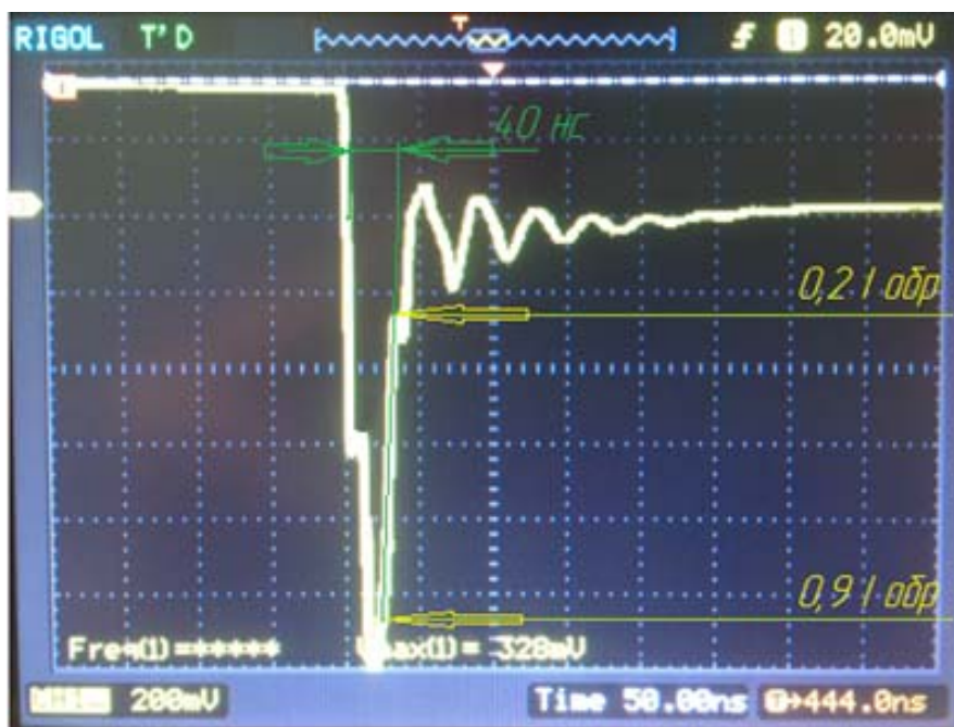
Рис.4. Время обратного восстановления для pin – GaAlAs 3x3 мм, составило 40 нс.
