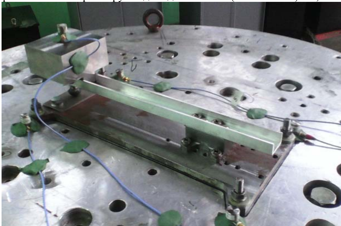
Рис. 2. Приспособление установлено на вибростенде
