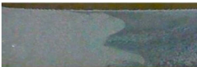
Рис. 3. Дефект волнистости соединения [3].
