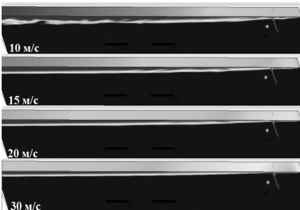
Рисунок 4 - Моделирование реального случая конденсации в диапазоне скоростей паровоздушной смеси 2...30[м/с] (Направление движение газовой смеси - справа налево)
