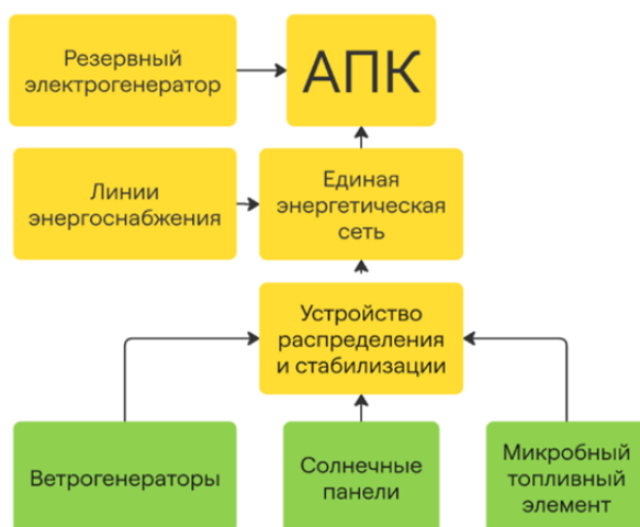
Схема работы гибридной энергосистемы АПК
