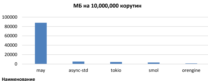
Рис. 2. Тест создание 10 000 000 спящих задач. По оси Y использованная память в МБ (меньше — лучше)
