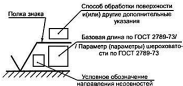
Рис. 1. Основные варианты обозначений шероховатости
