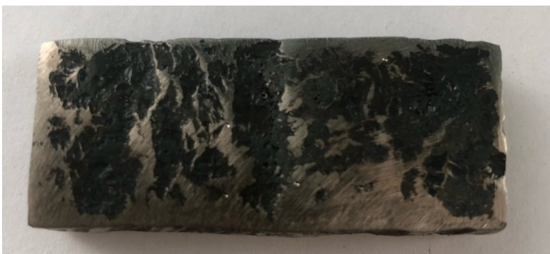
Рис. 4. Замер твердости покрытия, полученного проволокой ППН-502
