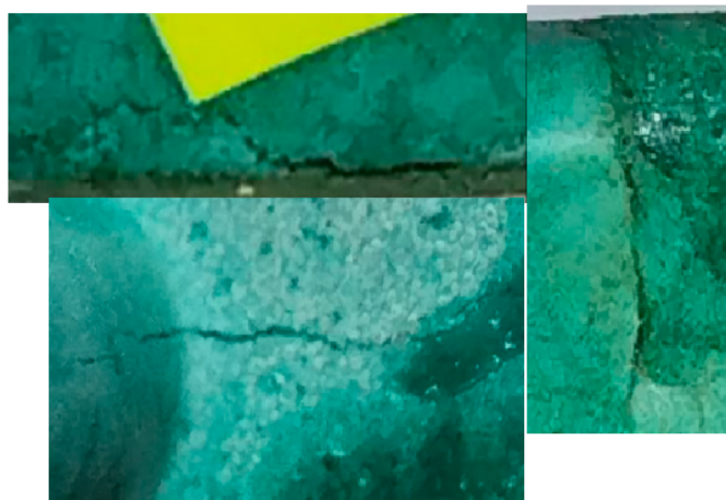
Трещины на ПЭН-У-300 после эксперимента
