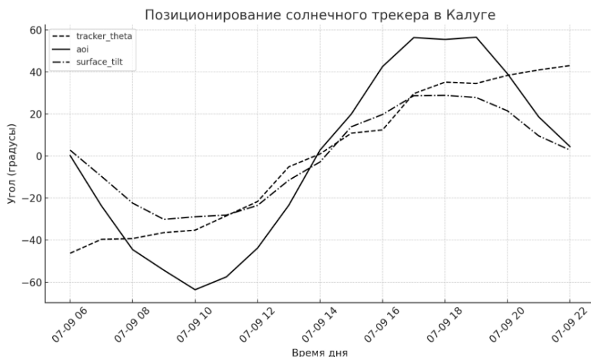
Рис. 1. Динамика углов поворота одноосного трекера в течение дня
