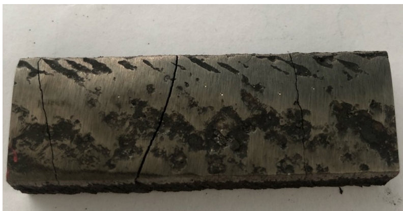
Рис. 3. Замер твердости покрытия, полученного проволокой ПП-3Х2В8
