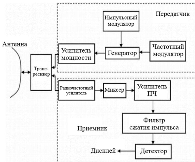
**Рис. 1.** Структурная схема сжатия импульса
