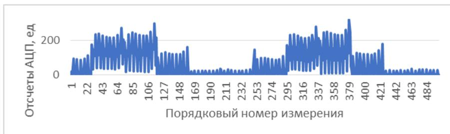
**Рис.1.** Измерение фазного тока без фильтрации
