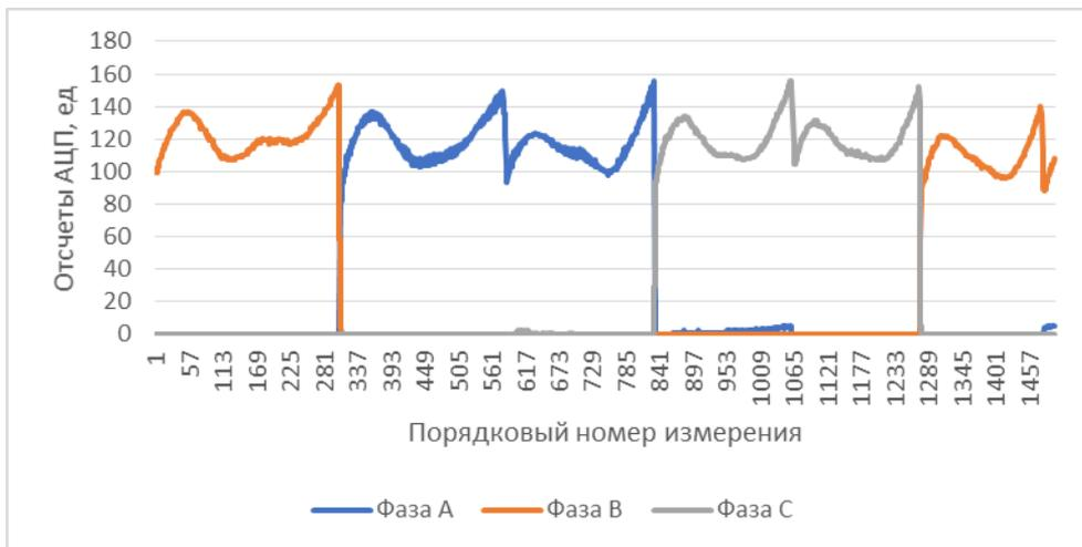
**Рис. 3.** Измерение фазных токов с предложенным алгоритмом фильтрации
