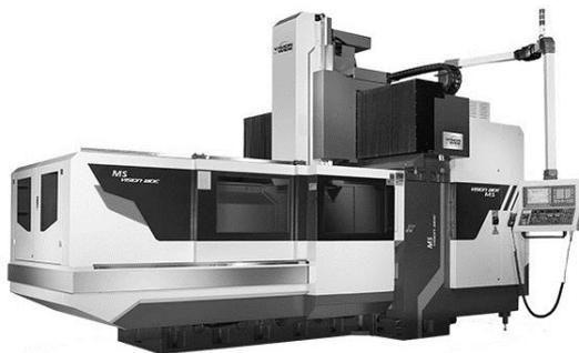
**Рис. 3.** Портальный фрезерный обрабатывающий центр MS-3120
