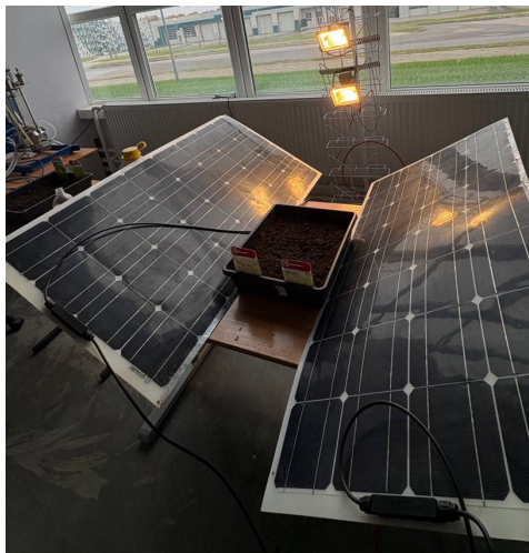
Рис. 1. Лабораторная модель агровольтаической системы
