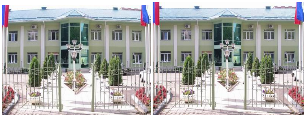
Рис. 1. Изображение с искажением (дисторсией) (а) и исправленное изображение (б)
