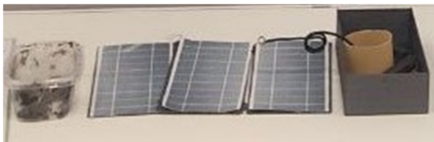
Рис. 3. Контейнер с высушенным активным илом и детали гибридного зарядного устройства
