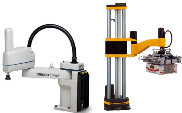
Рис. 1. Роботы SCARA с поступательным перемещением в конце и начале
