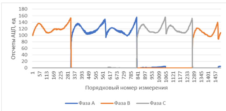
Рис. 3. Измерение фазных токов с предложенным алгоритмом фильтрации
