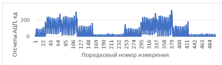
Рис. 1. Измерение фазного тока без фильтрации
