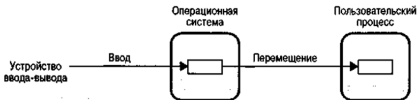
Рис. 2. Принцип работы с одинарной буферизацией
