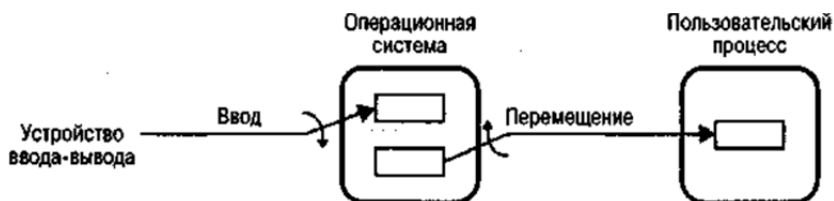
Рис. 3. Принцип работы с двойной буферизацией
