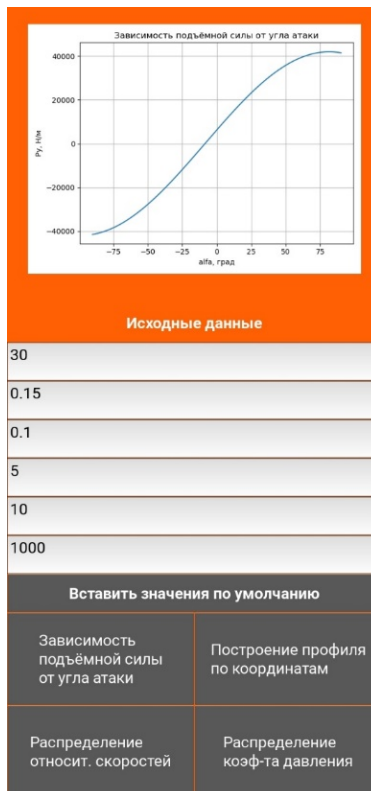
Рис. 2. Результат расчета зависимости подъемной силы, действующей на заданный профиль Жуковского, от угла атаки
