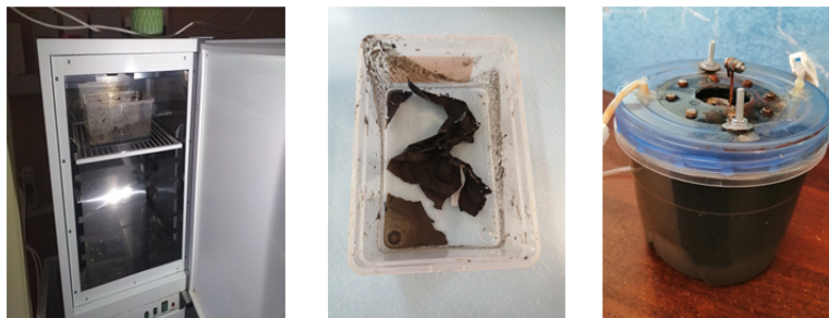
Рис. 1. Эксперимент по получению сухого активного ила
