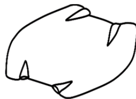
Рис. 4. Исходная заготовка для вытяжки корпуса часов [9]
