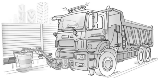
Рис. 1. Автомобиль с манипуляторной установкой для мойки барьерных ограждений
