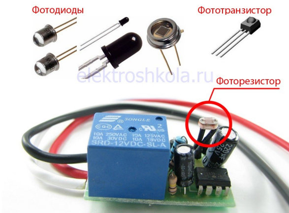
Рис. 1. Светочувствительные элементы, фоторезисторы, фотодиоды, фототранзисторы
