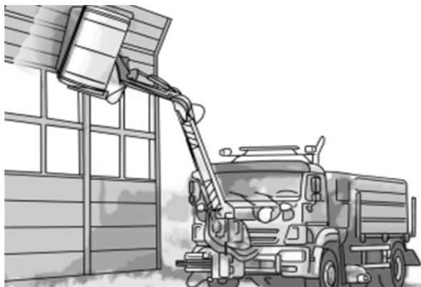
Рис. 3. Автомобиль с манипуляторной установкой большой грузоподъемности
