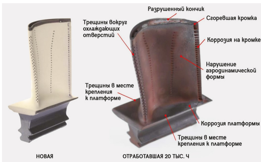
Рис. 1. Примеры типичных дефектов лопатки ГТД
