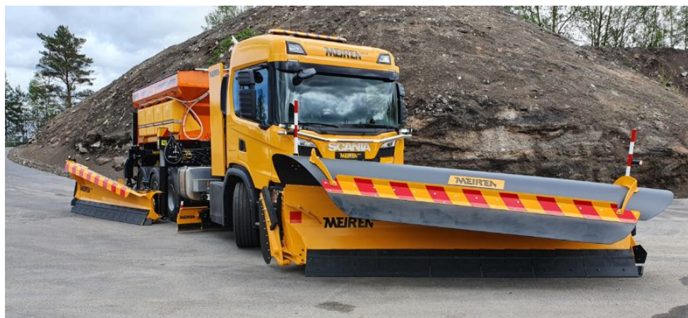
Рис. 2. Комбинация фронтального и бокового отвала для скоростной очистки
