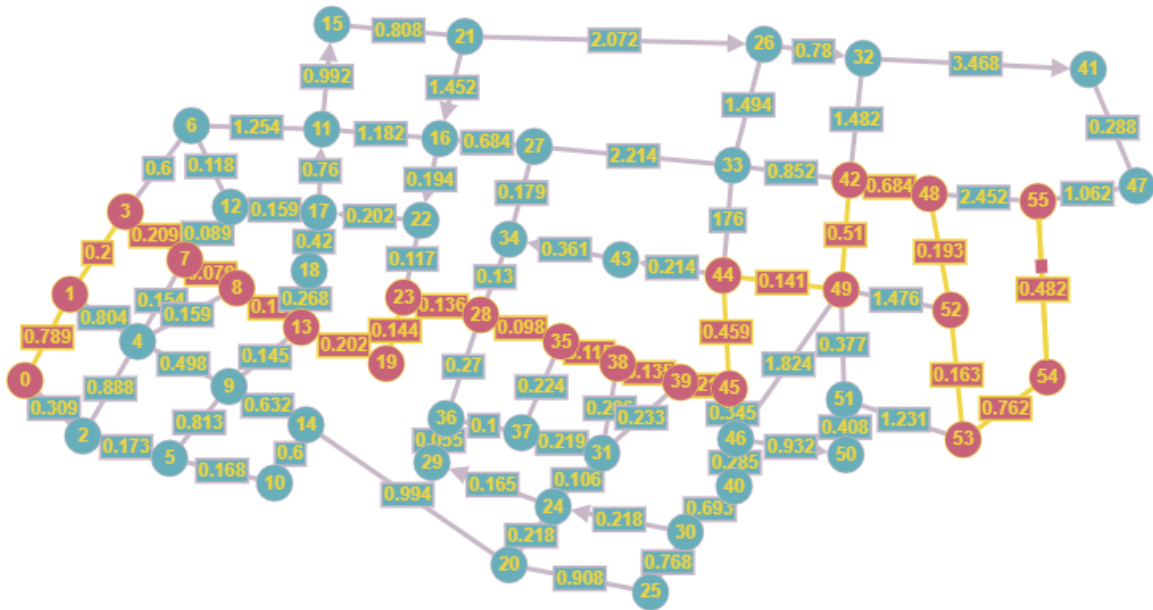
Рис. 5б. Кратчайшее расстояние из точки 0 в точку 55. Вес – время (минуты).
