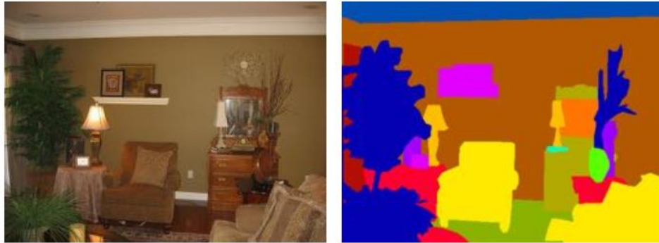
Рис 1. Иллюстрация семантической сегментации. Изображение (слева) сегментировано в области объектов (справа), представленных здесь различными цветами
