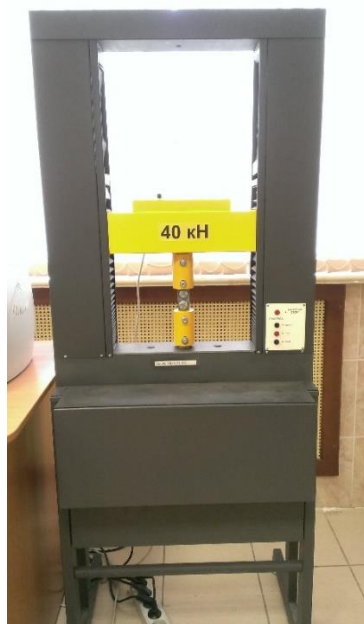
Рис. 3. Стенд МИ-40КУ с испытываемым образцом
