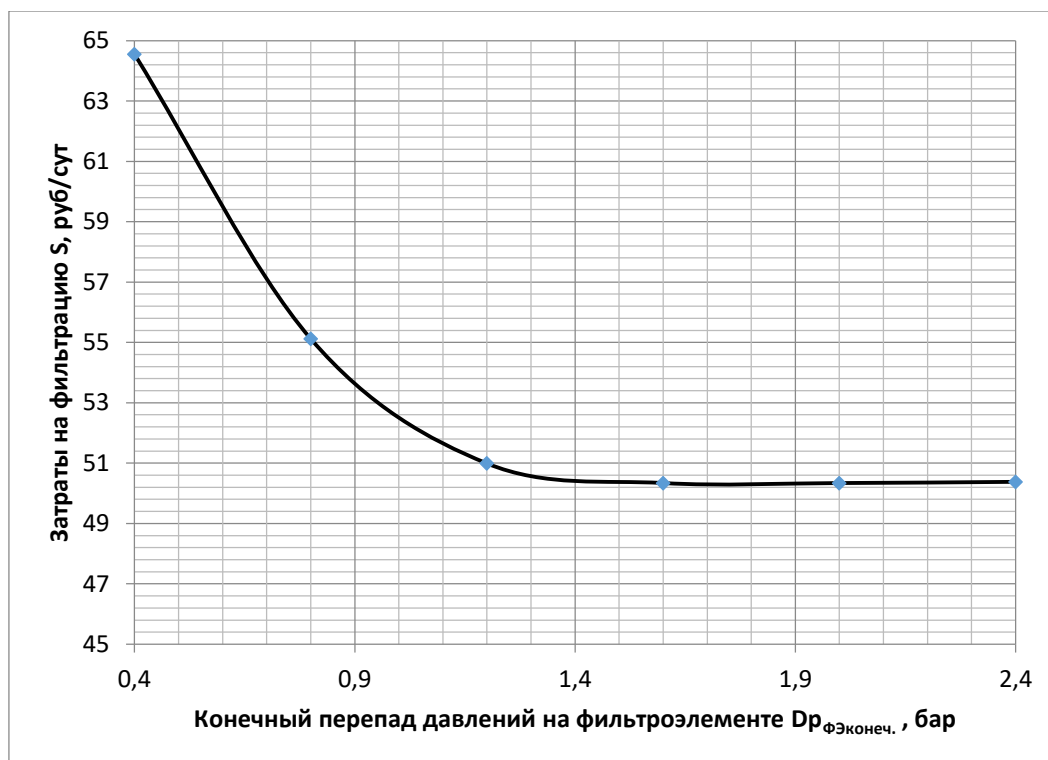
Рисунок 2 – График зависимости затрат на фильтрацию от конечного перепада давлений на фильтрующем элементе
