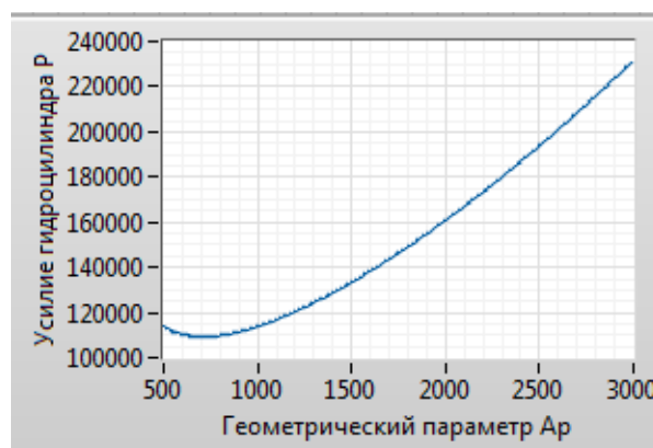
Рис. 5. График зависимости усилия гидроцилиндра от расположения передней измерительной тележки
