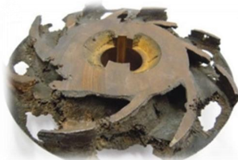
Рис. 1. Кавитационный износ рабочего колеса
