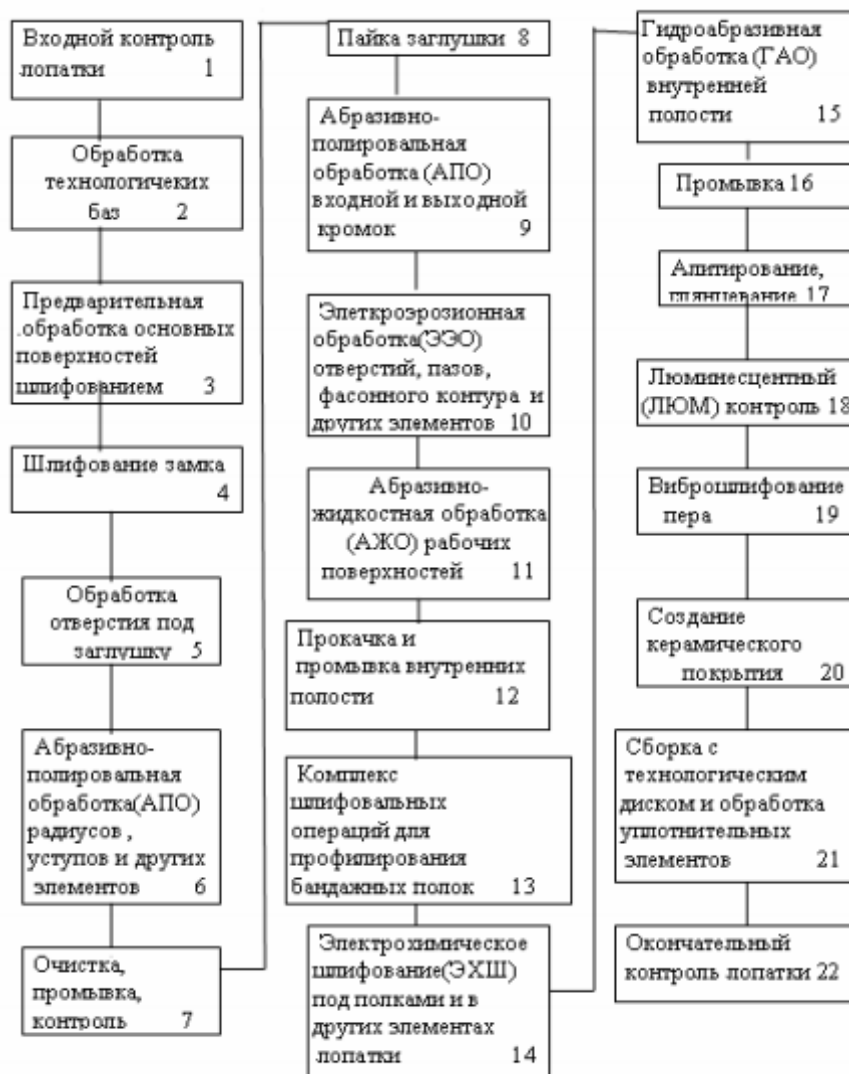
Рис.2 Технологический процесс обработки лопатки турбины
