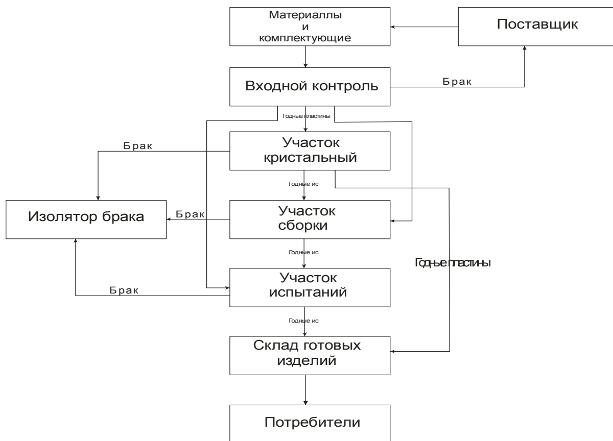
Рис. 2. Общая схема алгоритма производства ИС
