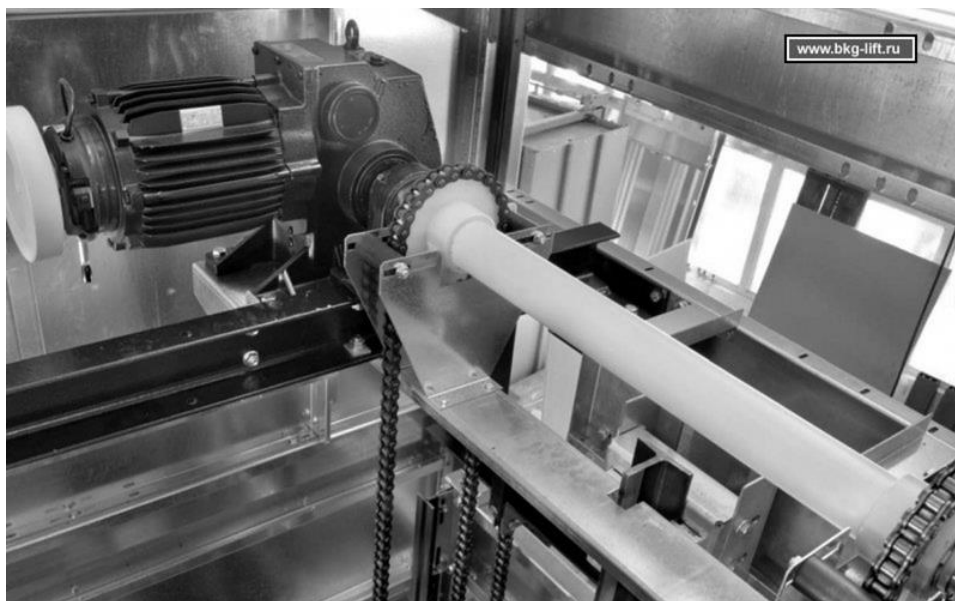
Рис.3. Лифт с тяговой звездочкой и цепью [5]
