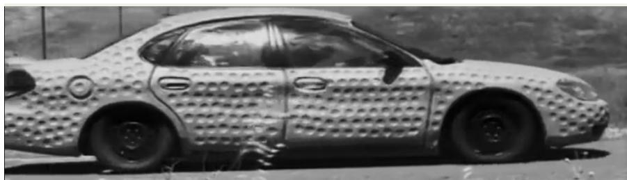
Рис. 5. Опытный автомобиль с ячеистым покрытием
