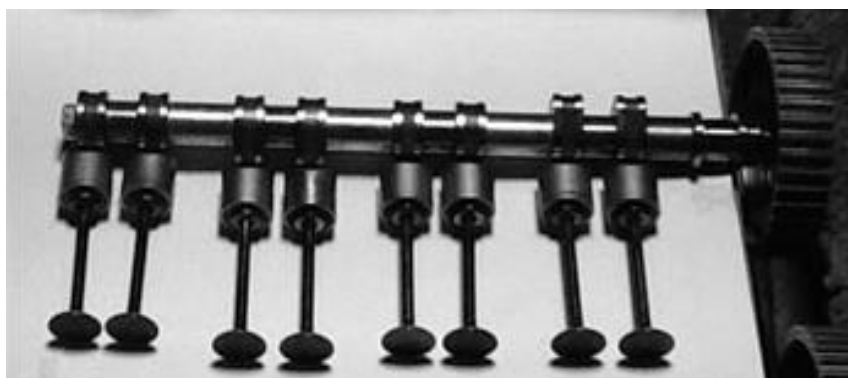
Рис. 2. Устройство привода клапанов без пружин
