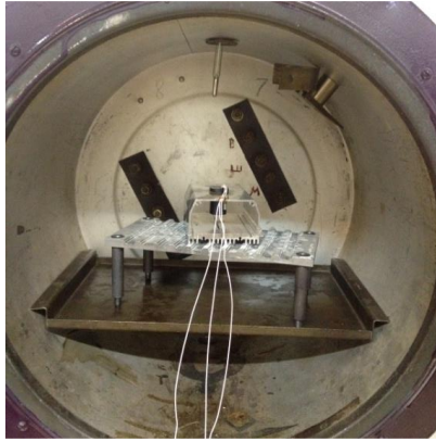
Рис. 2. Кристалл, помещенный в печь
