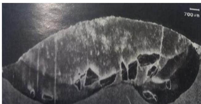
Рис. 5. Макроструктура валика при сварке в нижнем положении
