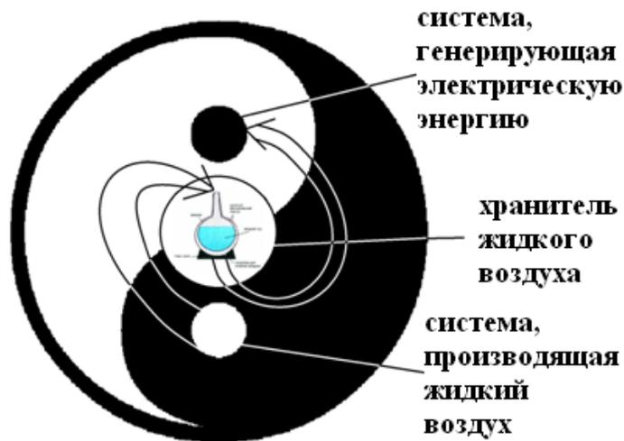
Рис. 2. Криогенная теплоаккумулирующая система
