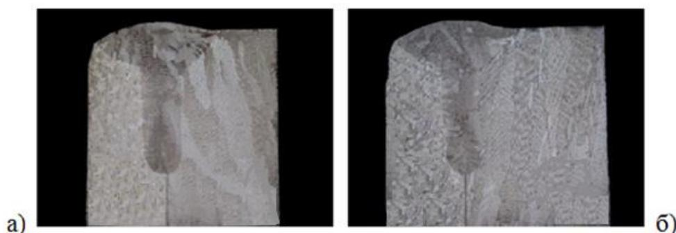
Рис. 3. Макрошлифы полученных соединений. а) – эталонный образец, б) – образец из выборки
