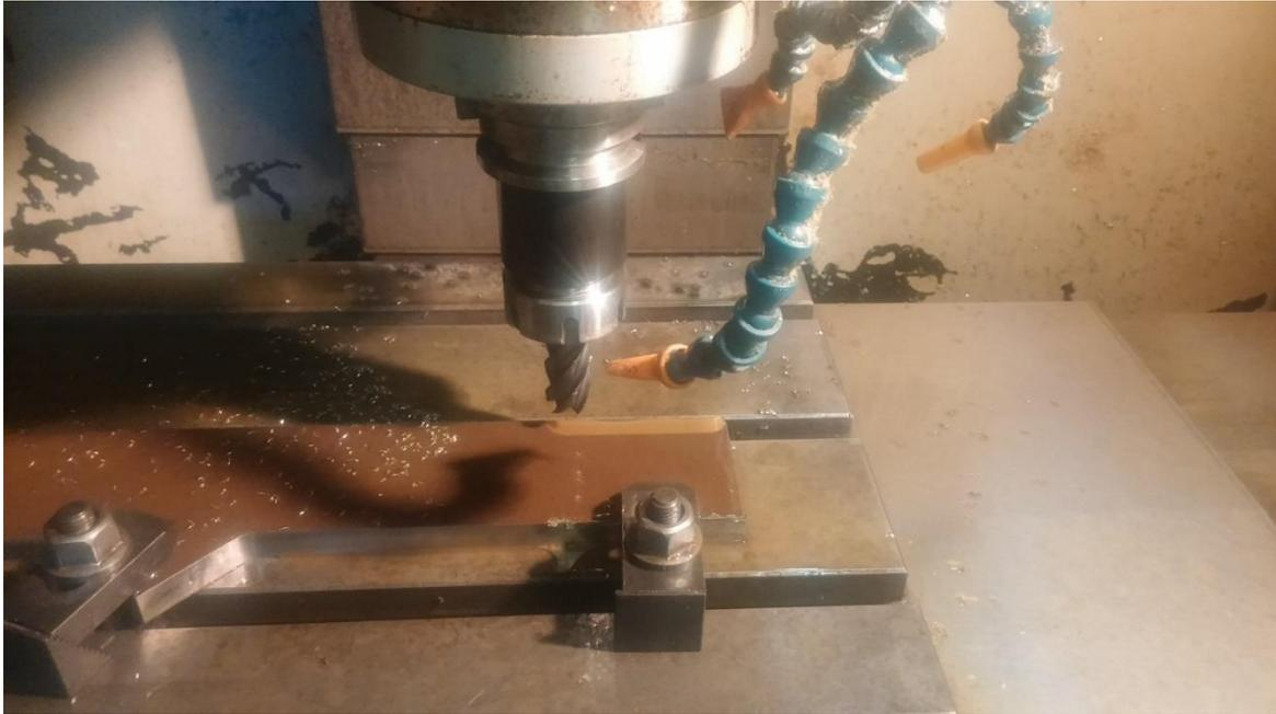
Рис. 1. Процесс обработки заготовки с использованием СОЖ
