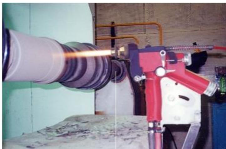
Рис. 3. Процесс наплавки газопламенным способом
