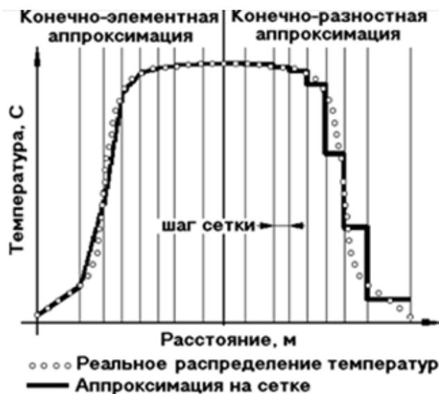
Рис. 4. Пример аппроксимации функциональной зависимости методами «МКР» и «МКЭ»
