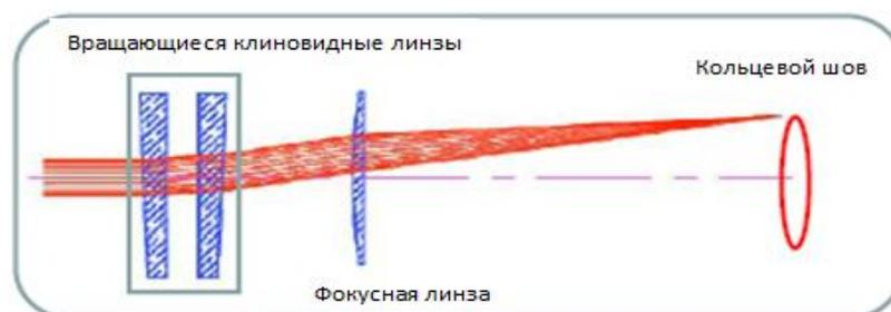
Рис. 1. Схема установки для лазерной сварки
