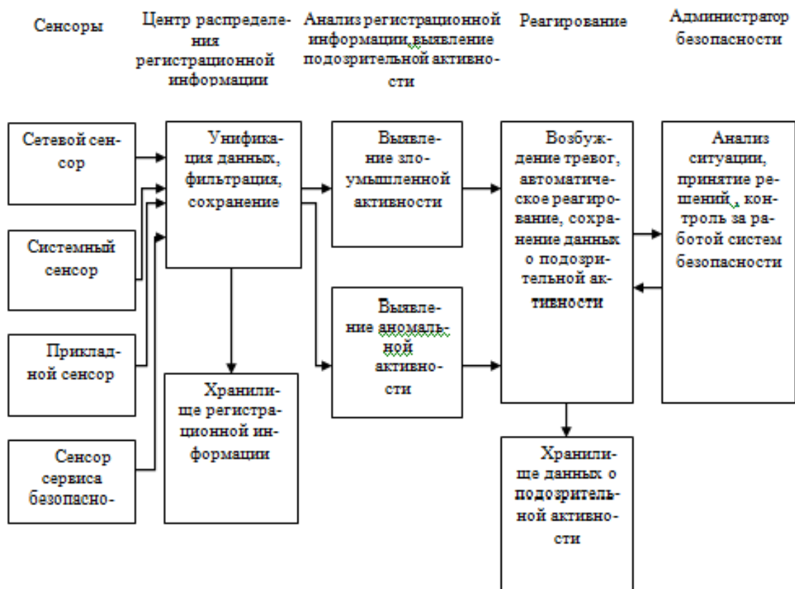
Рис.1 Связь между основными элементами локальной архитектуры СОВ
