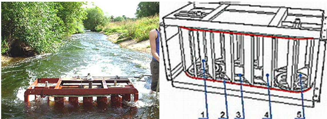
Рис. 3 Бесплотинная всесезонная гидроэлектростанция
