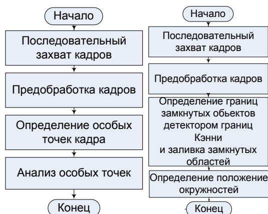
Рис.2. Алгоритмы распознавания глаз: Метод основанный на поиске особых точек(слева), метод основанный на выделении границ(справа)
