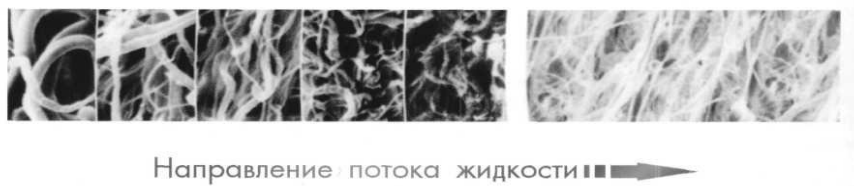
Рис. 1. Структура фильтроматериала по ТУ У 54008400.001
