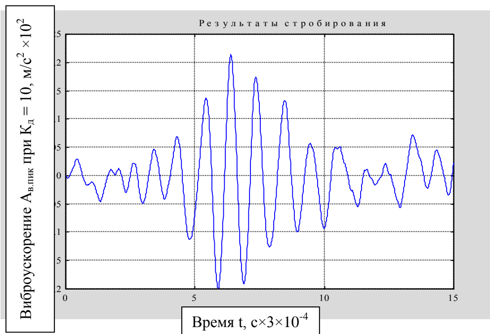
Рис. 2. Результаты стробирования виброинформации
