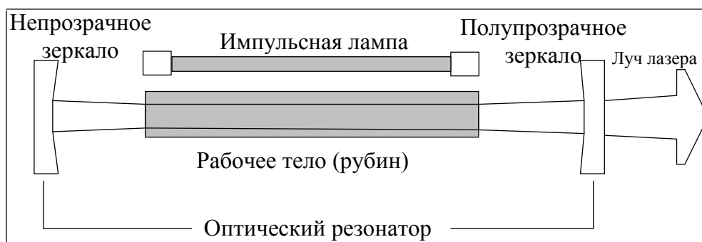
Рис. 1. Схема твердотельного рубинового лазера
