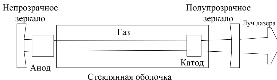
Рис. 2. Схема газового лазера
