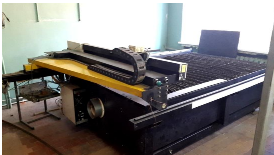
Рис. 1 Установка лазерной резки ЛТ-400И
