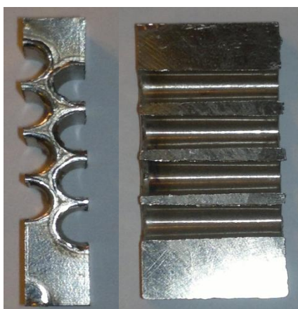
Рис.1. Общий вид соединения трубок с трубной доской.
