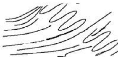
Рис. 1. Структура аморфного полимера (Модель Вайнштейна)
