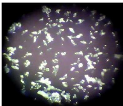
Рис. 3. Фотография кристаллов карбоната кальция на предметном стекле для пробы, подвергнутой лазерному облучению воды
