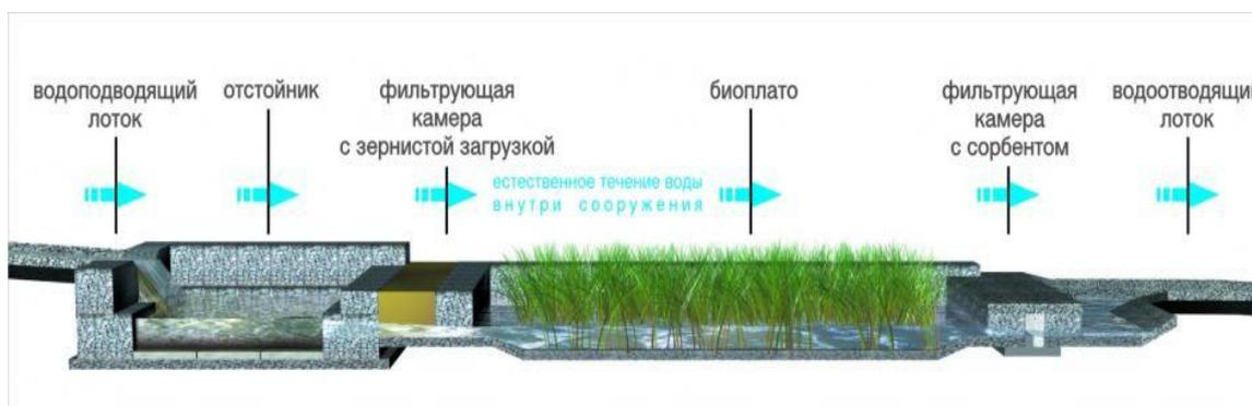
Рис. 1. Схема габионных очистных фильтрующих сооружений ливневых стоков
