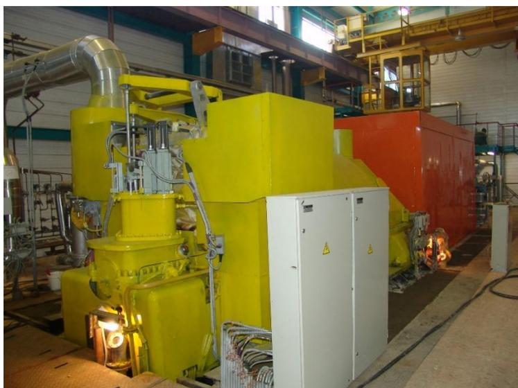
Рис. 3. Блочная турбогенераторная установка мощностью 10 МВт (Т-10-5,2) производства КТЗ, оснащённая современной системой автоматического регулирования, на заводском испытательном стенде
