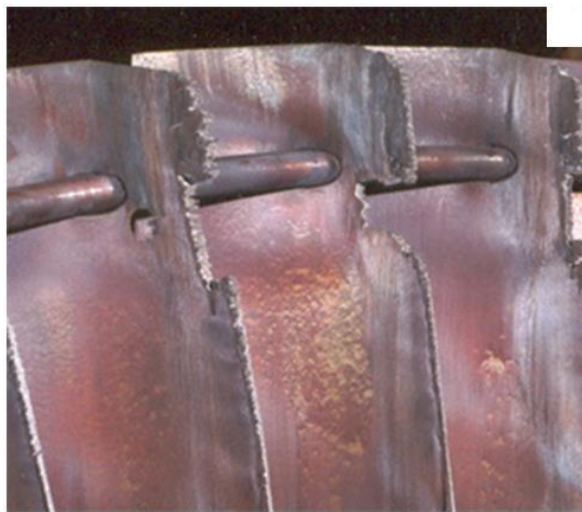
Рис. 1. Поврежденные лопатки последней ступени ЦНД
