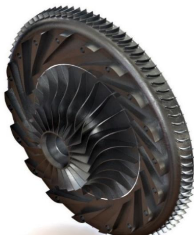
Рис. 2. 3D-модель элементов проточной части ступени компрессора
