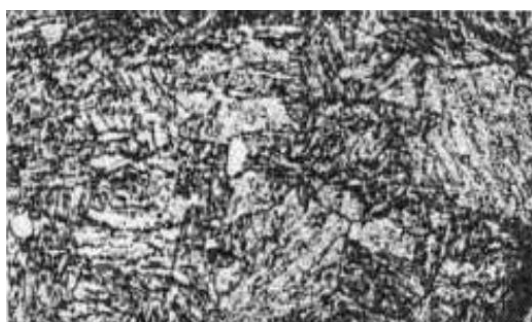
Рис. 3. Структура сплава ВНЛ-5 (увеличение x150)
