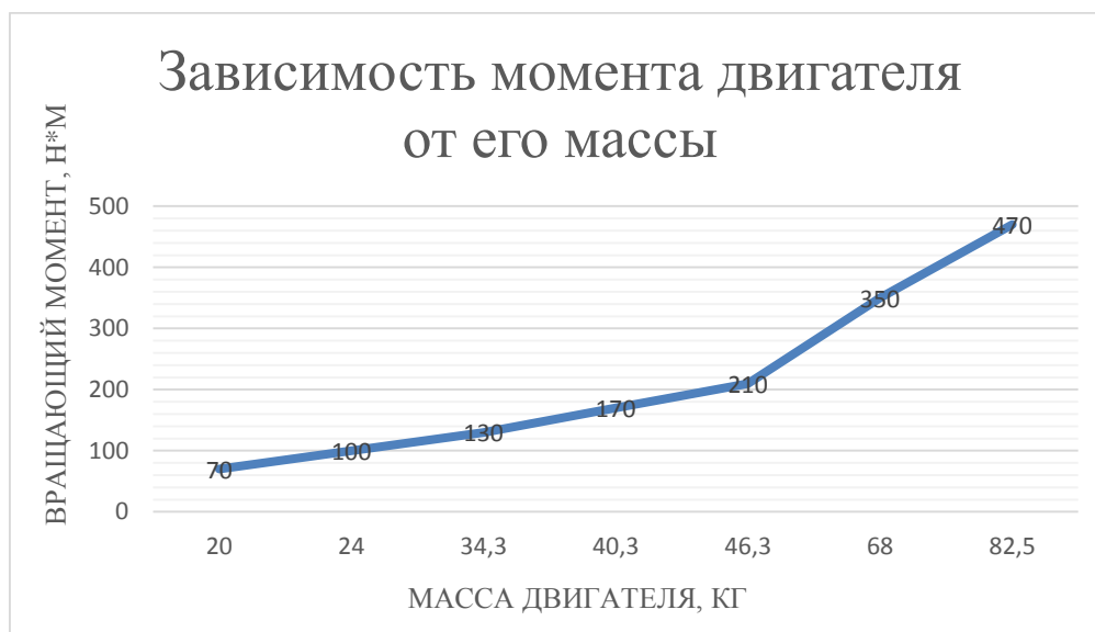
Рис. 2. График зависимости вращающего момента от массы двигателя
