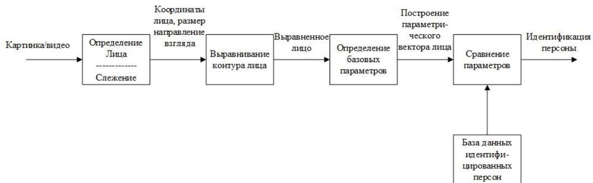
Рис. 1. Общий процесс обработки изображения лица при распознавании
