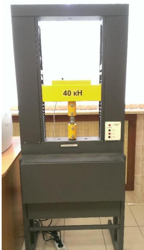
Рис. 4 Стенд МИ40КУ с испытательным образцом
