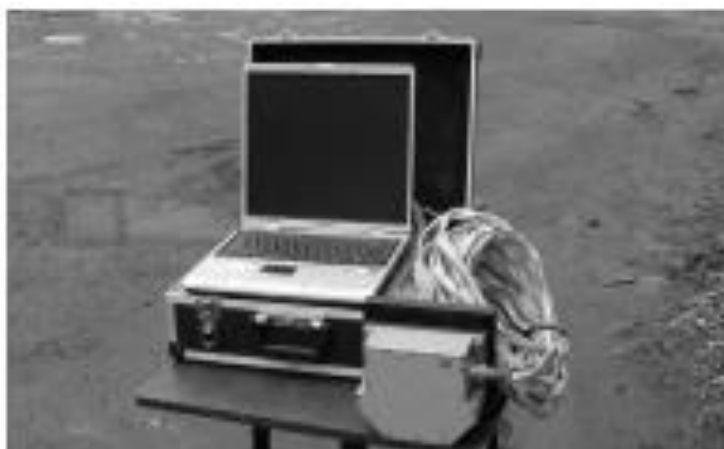
Рис. 2. Автоматизированный контрольно-испытательный комплекс для дорожных испытаний транспортных средств
