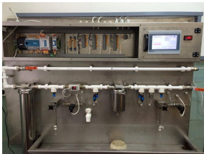
Рис. 2. Гидравлический стенд для проведения ресурсных испытаний
