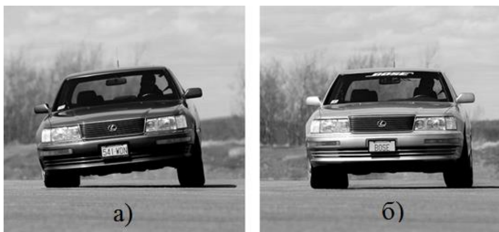
Рис. 2. Сравнение поведения автомобиля со стандартной подвеской (а) и подвеской Bose (б) в повороте
