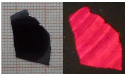
Рис. 2. Фотографии образца LS2-B в обычном и поляризованном свете. Видны полосы роста, обусловленные неоднородным распределением состава кристалла
