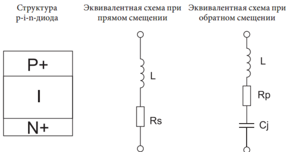
Рис. 1. Структура p-i-n -диода и его эквивалентные схемы [3]
