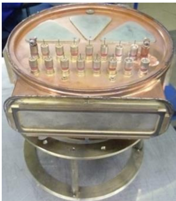
Рис. 2а. Внешний вид рентгеновской трубки со стороны накальных выводов многоэмиттерного катодного узла
