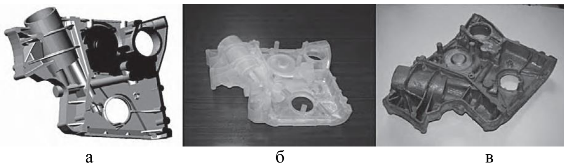
Рис. 2. САD-модель (а), SLS-модель (б) и отливка передняя крышка ДВО, полученная в ПФ (в)
