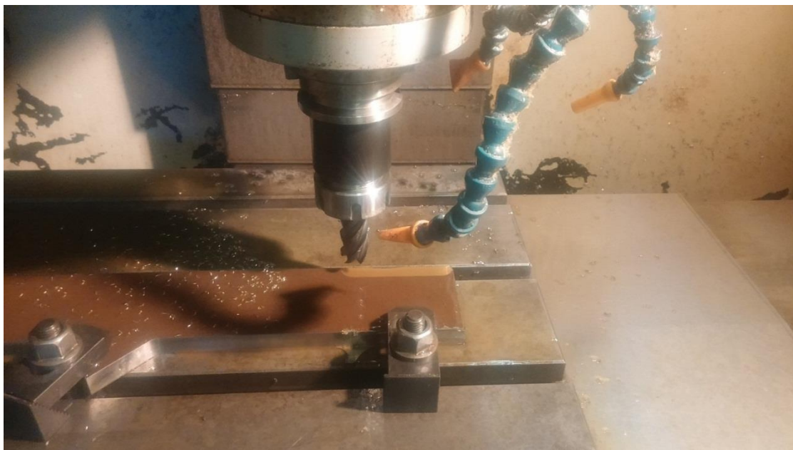
Рис. 1. Процесс обработки заготовки с использованием СОЖ
