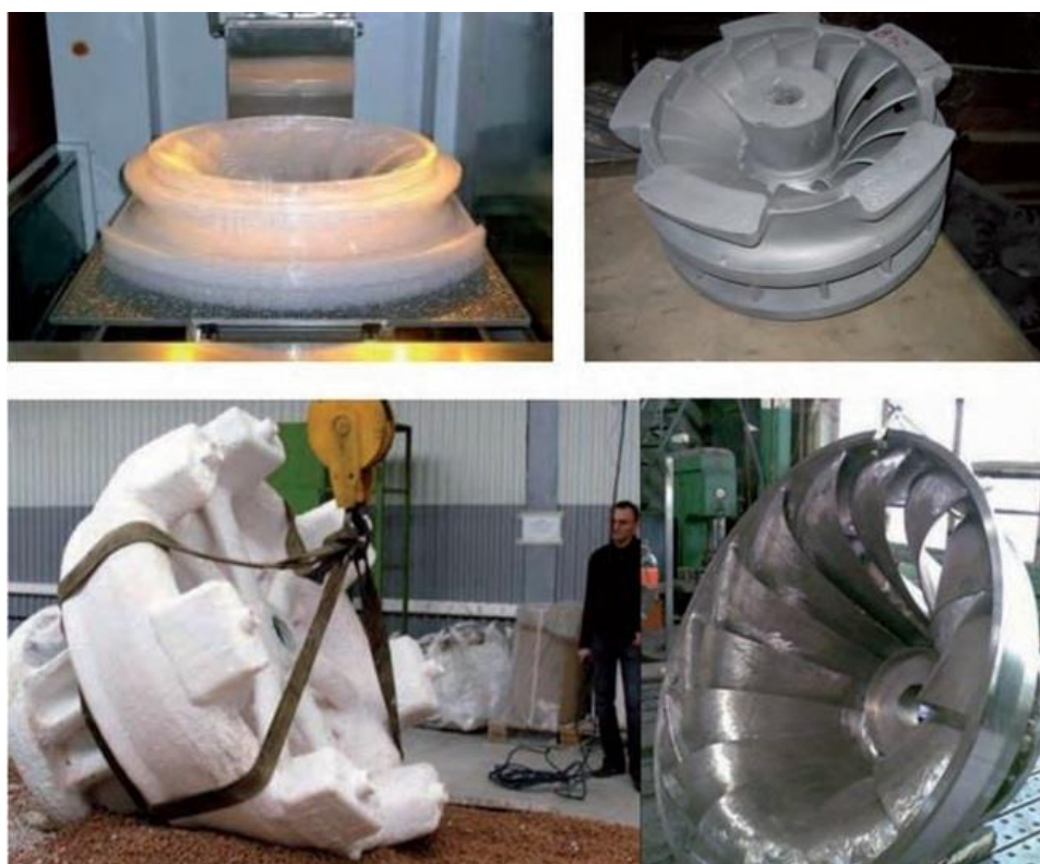
Рис. 3. SLA-модель (а) и отливка рабочее колесо турбоагрегата (б), оболочковая форма и отливка рабочее колесо турбины ОАО «ТМЗ» (в)
