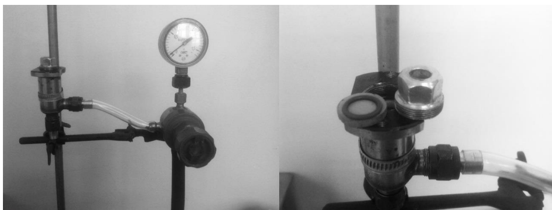
Рис. 2. Общий вид установки (слева) и ячейка для измерения дискового образца (справа)
