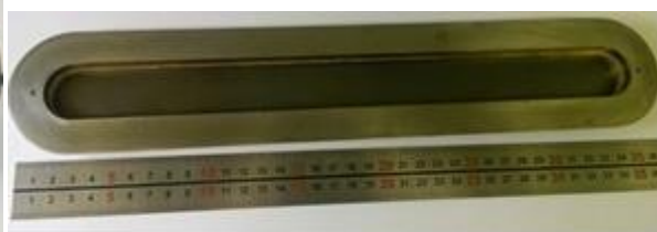
Рис. 4. Выводное бериллиевое окно с апертурой 320x30мм
