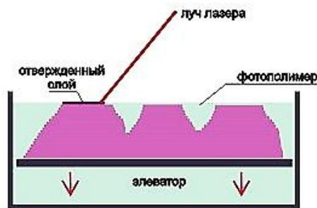
Рис. 2 Принципиальная схема функционирования «SLA» технологии
