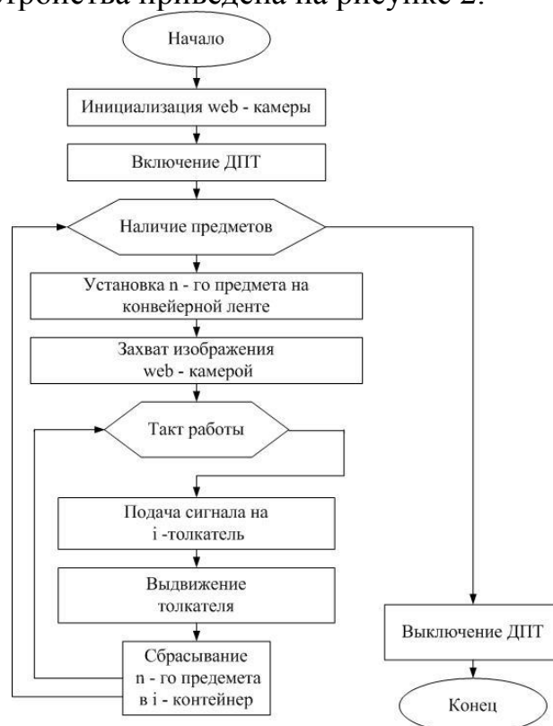
Рисунок 2 – Блок – схема системы управления транспортной лентой
