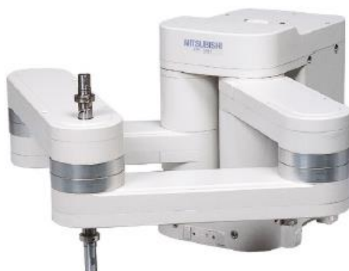
Рисунок 5 – Робот MELFA RP-1A компании Mitsubishi Electric [6].
