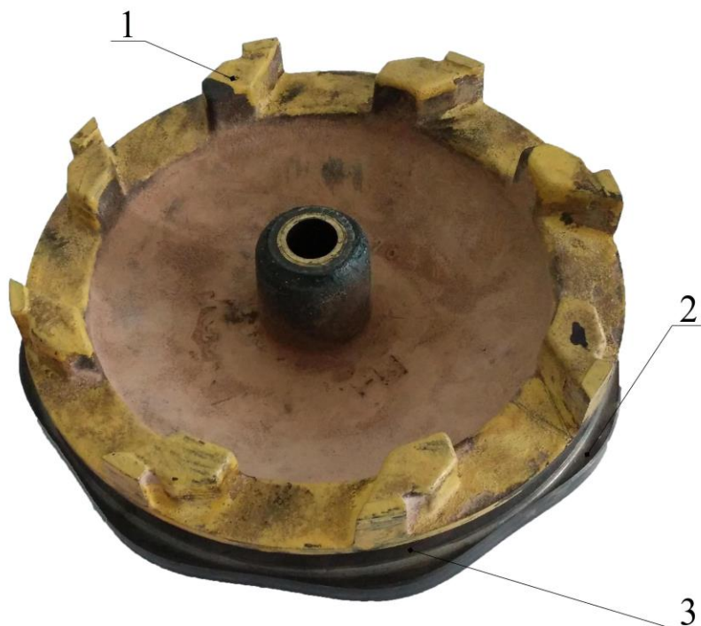
Рис. 1. Восьмигранный диск ограничителя скорости с инерционным роликом: 1- кулачок; 2- профиль; 3-ручей
