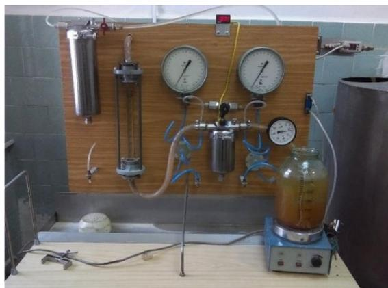
Рис. 3. Лабораторный стенд для контроля качества фильтров для жидких сред
