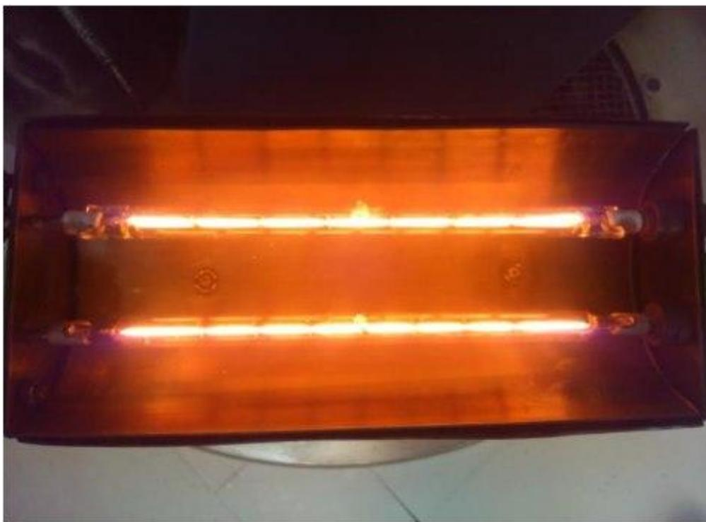
Рис. 2. Фото модернизированного термического источника с двумя нагревательными лампами
