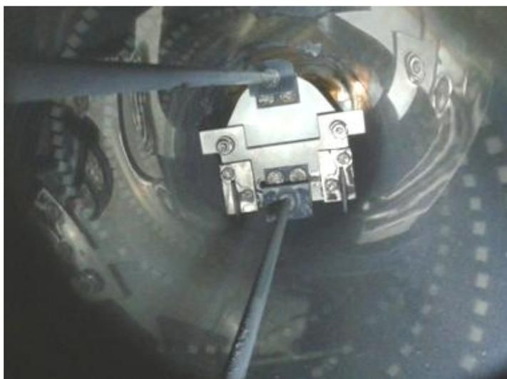
Рис.1. Электроды соединенные с графитовыми контактами загруженной в камеру кассеты
