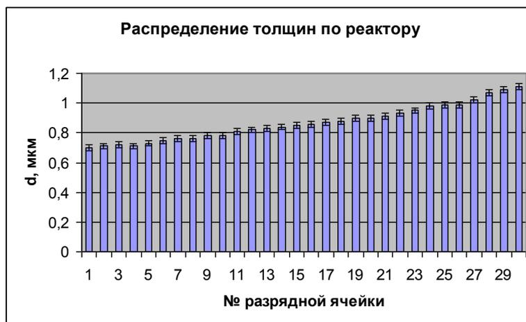
Рис. 2. График распределения толщины осажденного окисла по кассете
