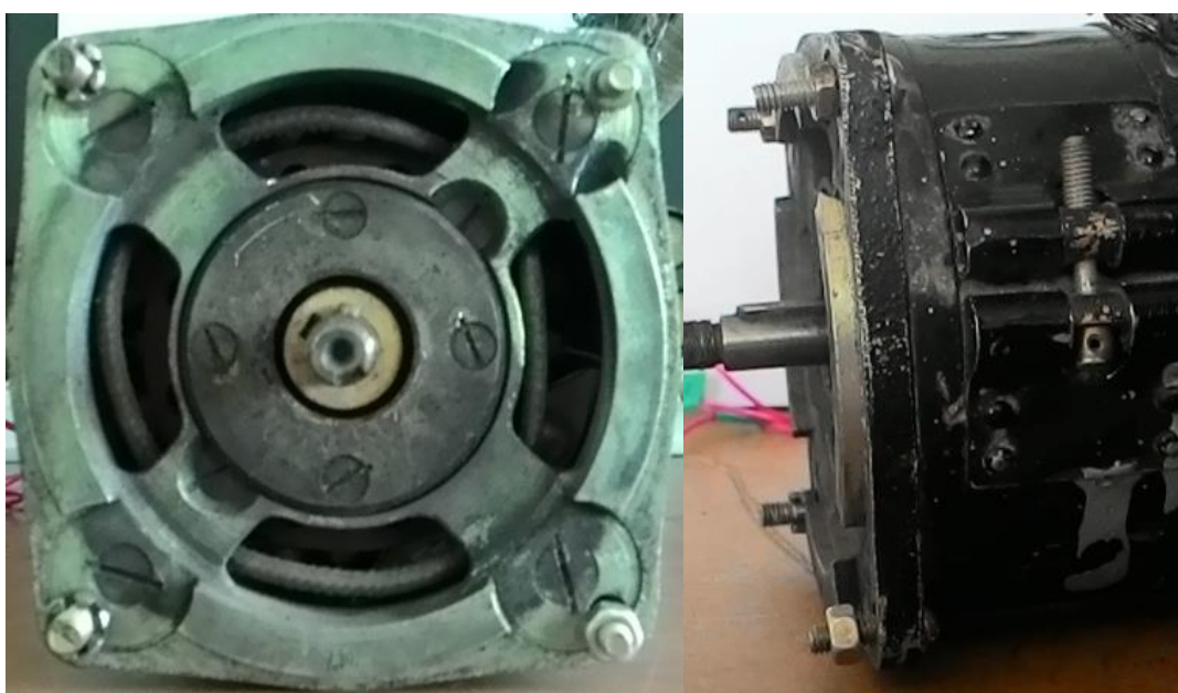
Рис. 5. Корпус двигателя после демонтажа электромеханического тормоза
