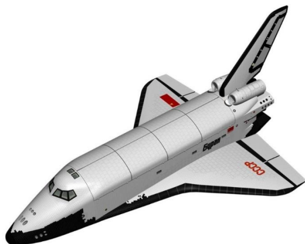
Рис. 5 Конфигурация орбитального корабля «Буран» с двумя модернизированными ТРДДФ на базе двигателя АЛ-41Ф
