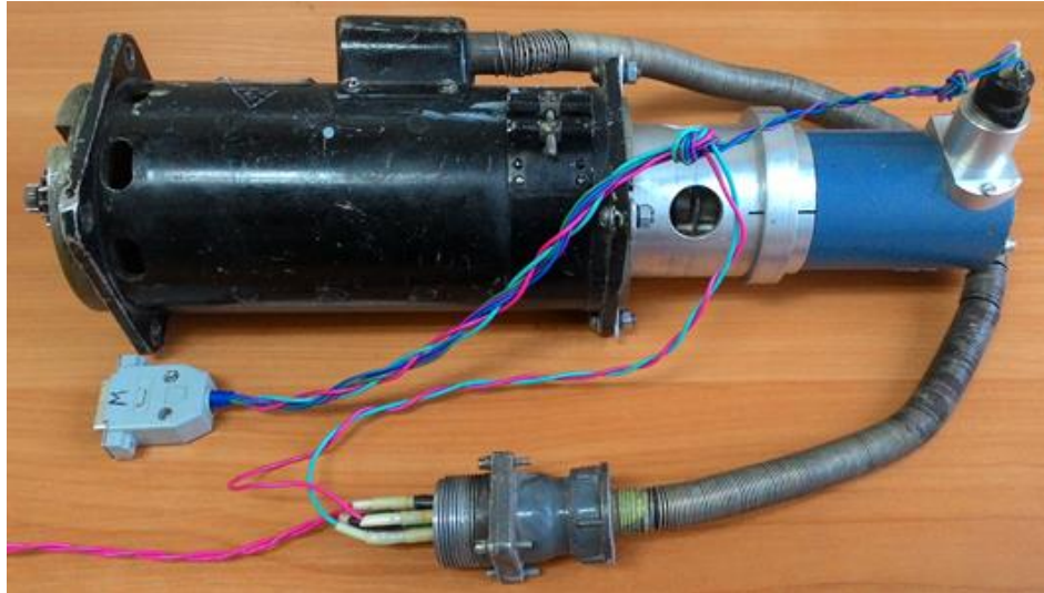
Рис. 6. Двигатель Д600-ТФ в сборке с кодовым датчиком IRC 120/1000
