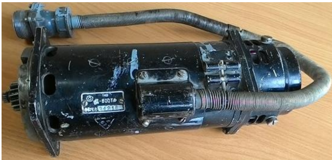
Рис. 1. Двигатель постоянного тока Д-600ТФ
