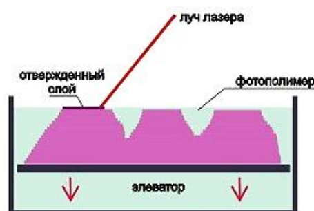
Рис. 2. Производственная схема принципа работы «SLA» технологии
