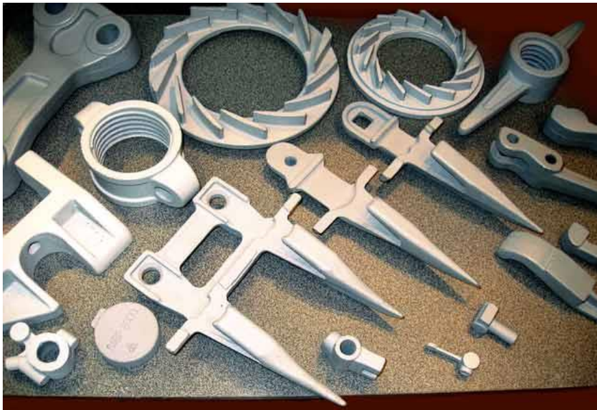
Рис. 1. Компоненты дорожно-строительной техники, отлитые методом ЛГМ
