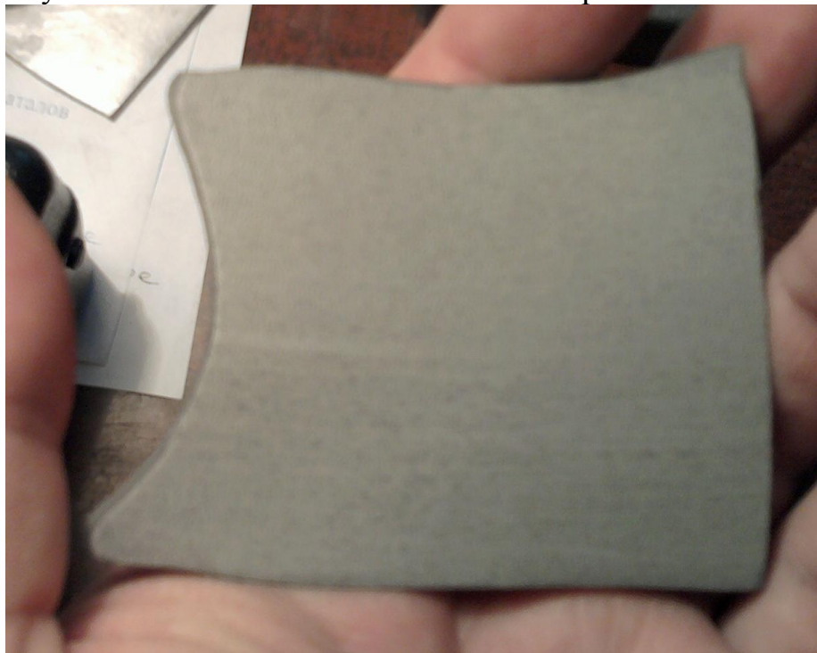
Рис. 4. МДО-покрытие листа из циркония 702, полученное в кислотном электролите.
